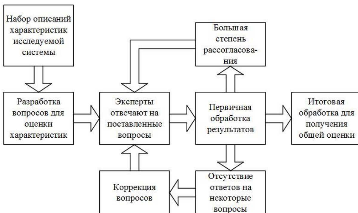
Рис. 2.1. Алгоритм получения экспертных оценок качественных параметров.
