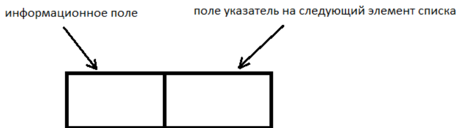
Рис. 12. Схематичное отображение элемента динамического списка
