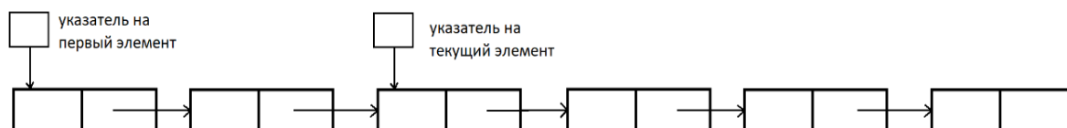
Рис. 14. Схематичное представление линейного списка и указателей, настроенных на первый и текущий элементы
