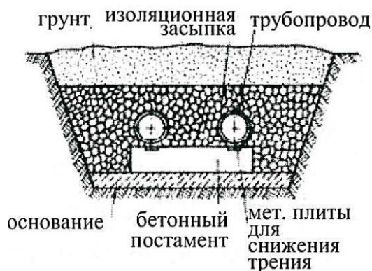
Рис. 7.4. Засыпная изоляция, выполняемая непосредственно в траншее
