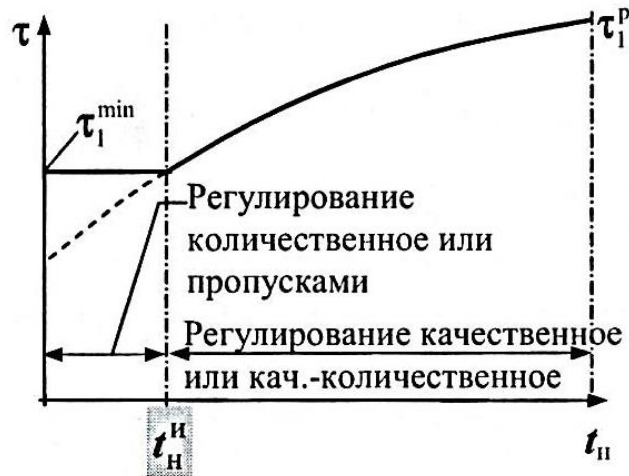
Рис. 3.11. Принципы комбинированного регулирования разнородной нагрузки
