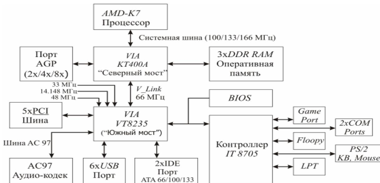
Рис. 1.2. Структурная схема системной платы GA-7VA на чипсете VIA KT400A
