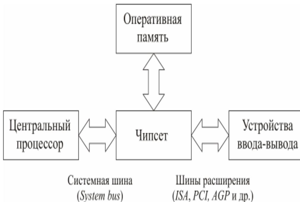
Рис. 1.1. Обобщенная структурная схема системной платы
