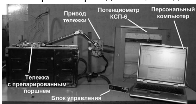
Рис. 79. БТС для исследования термостойкости поршней
