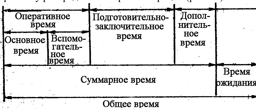
Рис. 19. Распределение времени при выполнении технического обслуживания и ремонта
