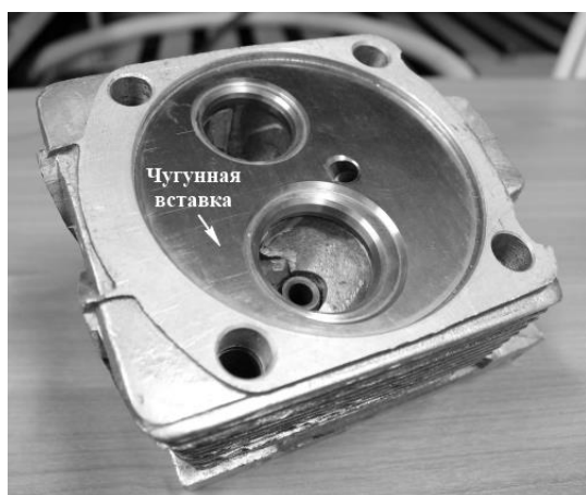
Рис. 59. ГЦ дизеля 4ЧН 10,5/12 (Д-145Т) армированная чугунной вставкой
