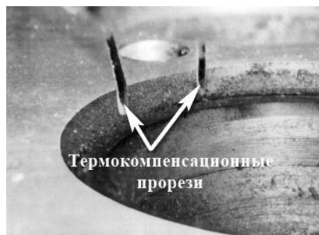
Рис. 57. Термокомпенсационные прорезы на днище ГЦ 12Ч 13/14 (ЯМЗ-240Б)
