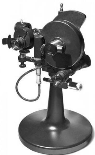
Рис. 103. Рефрактометр ИРФ-23 (типа Пульфриха)
