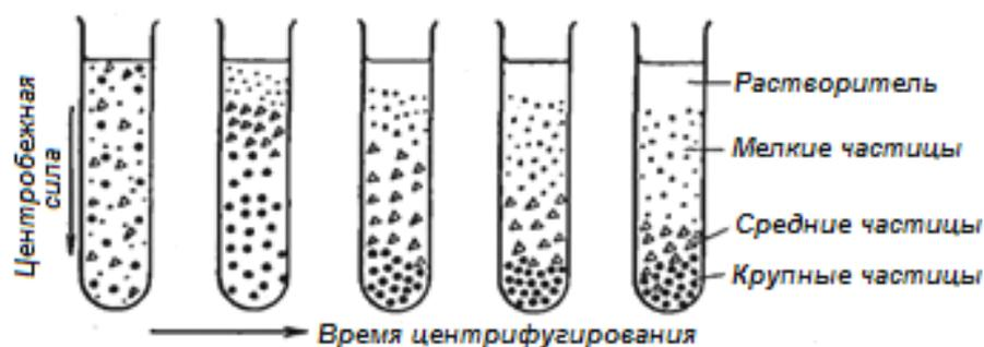
Рис. 2. Дифференциальное центрифугирование [47, с. 169]
