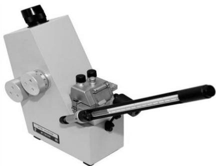
Рис. 100. Рефрактометр ИРФ-454-Б2М (типа Аббе)
