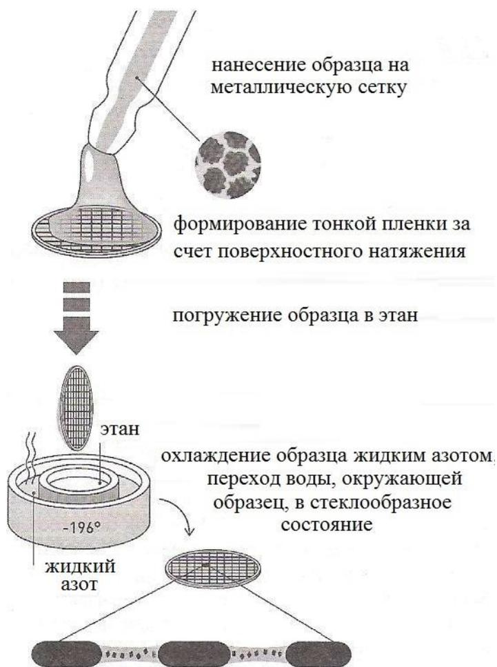
Рис. 91. Методика приготовления образца для криоэлектронной микроскопии [17, с. 9]
