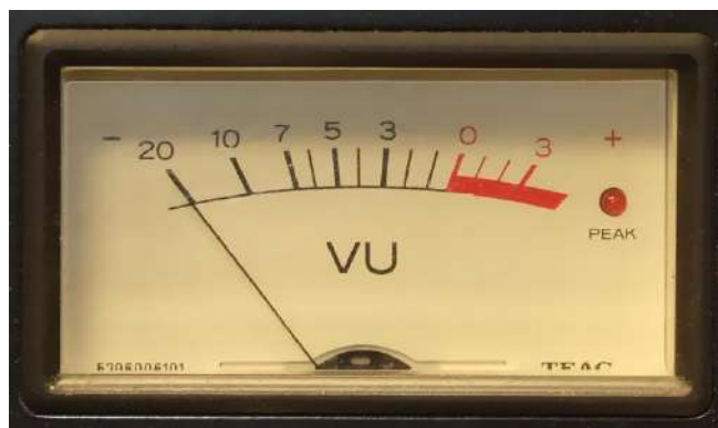
Рис. 4.55. Аналоговый измеритель уровня звука (VU-метр)
