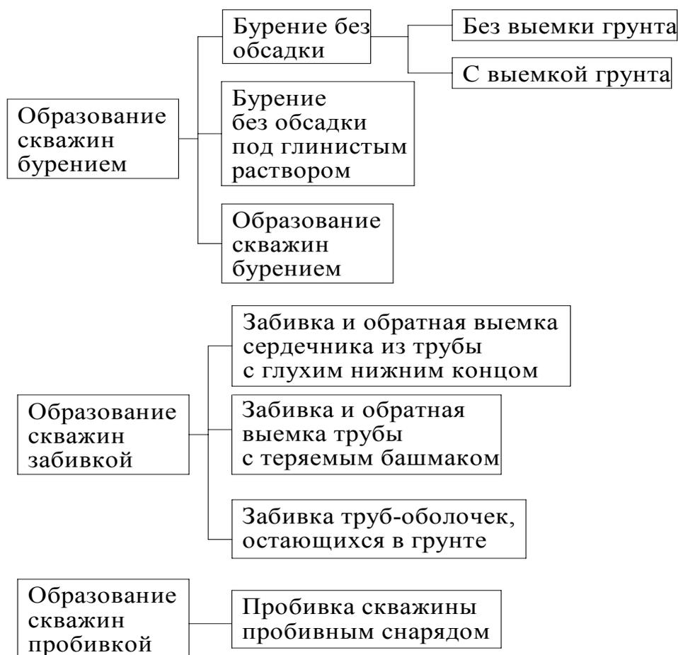
*Рис.61. Способы образования скважин под набивные сваи*
