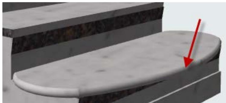
Контур и базовая линия лестницы редактируются и вне режима редактирования. Так, на уровне контура можно изменять форму конструкции, при этом положение линии хода не меняется
