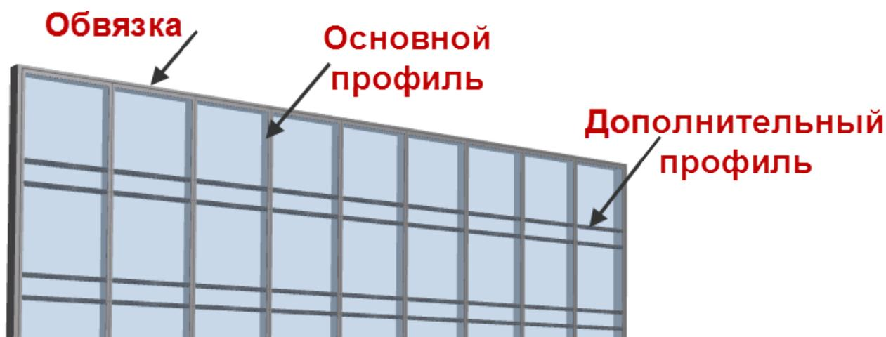
Обвязка определяет границы навесной стены, основные и дополнительные рамы могут устанавливаться во взаимно противоположных направлениях, перпендикулярно друг другу или под углом.
