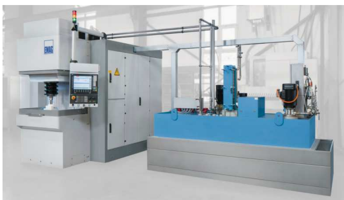
Рис. 35. Внешний вид станка ЕСМ для снятия заусенцев методами ЭХО модели PTS 2500 [22]
