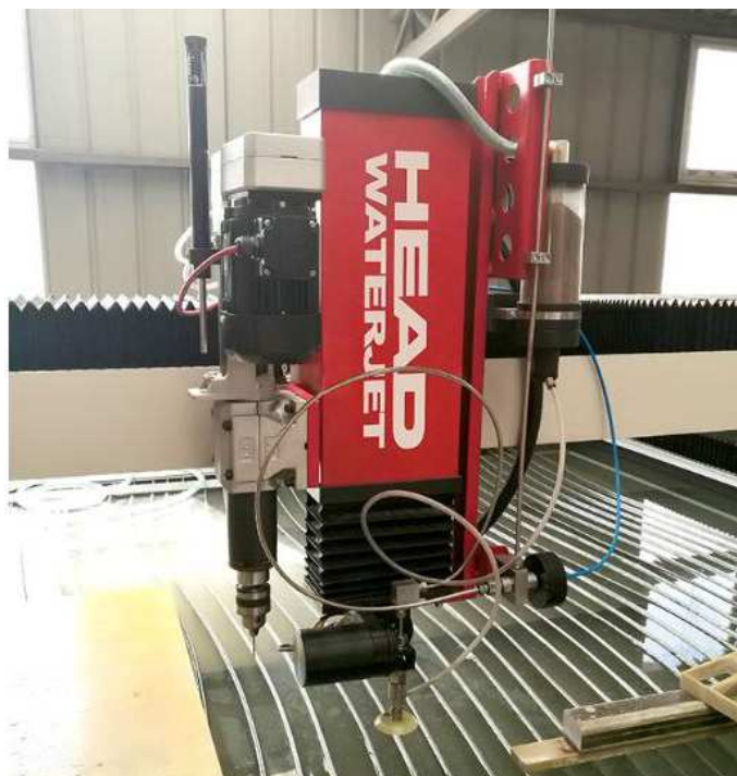
Рис. 62. Внешний вид сверлильной головки HeadWaterJet [38]
