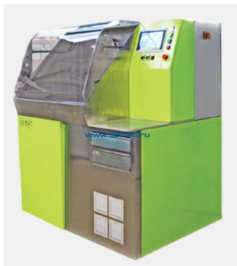
Рис. 9. Внешний вид станка модели Sk-ECM450D для электрохимического удаления заусенцев [11]
