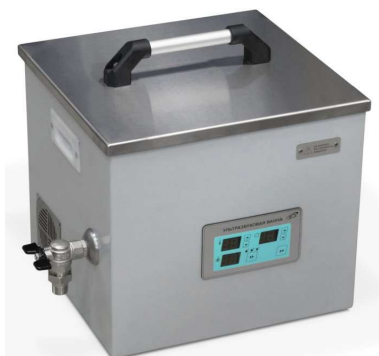
Рис. 57. Внешний вид ультразвуковой ванны модели МО-915 [35]
