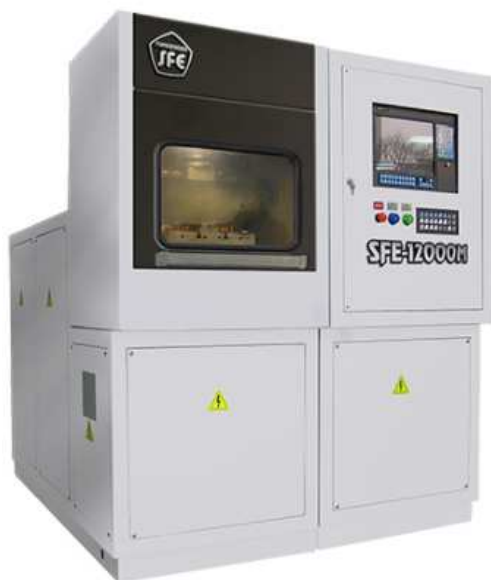
Рис. 11. Внешний вид электрохимического копировально-прошивочного станка SFE-12000M [12]
