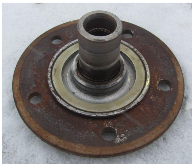
Рис. 1. Передняя ступица автомобиля ВАЗ-2121 (и всех его модификаций)
