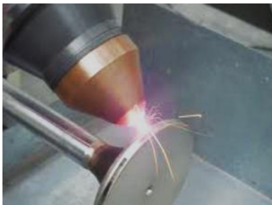
Рис. 2. Лазерная наплавка клапана ДВС
