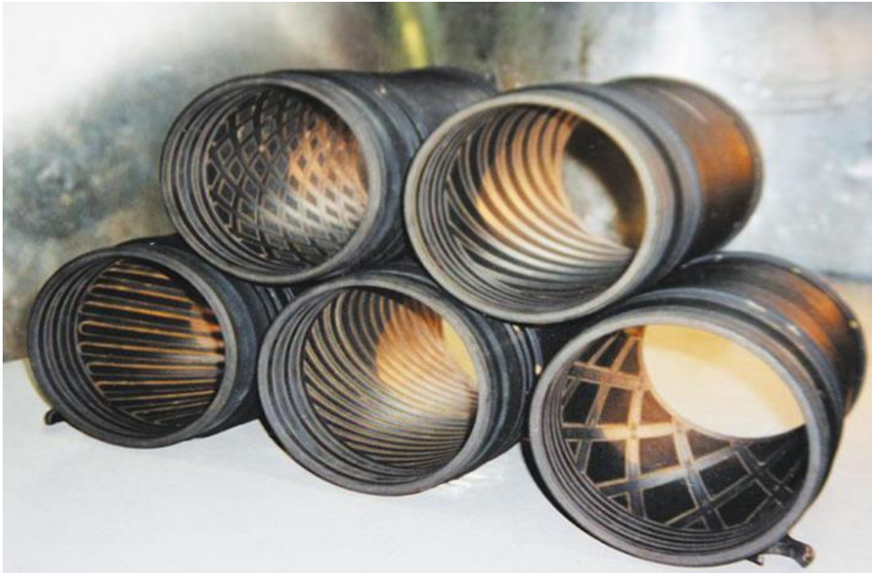
Рис. 5. Обработанные гильзы цилиндра ДВС
