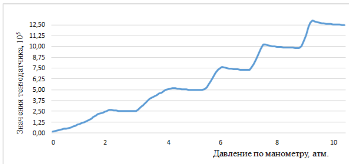
Рис. 5. Показания тензопреобразователя от 0 до 10 атм.
