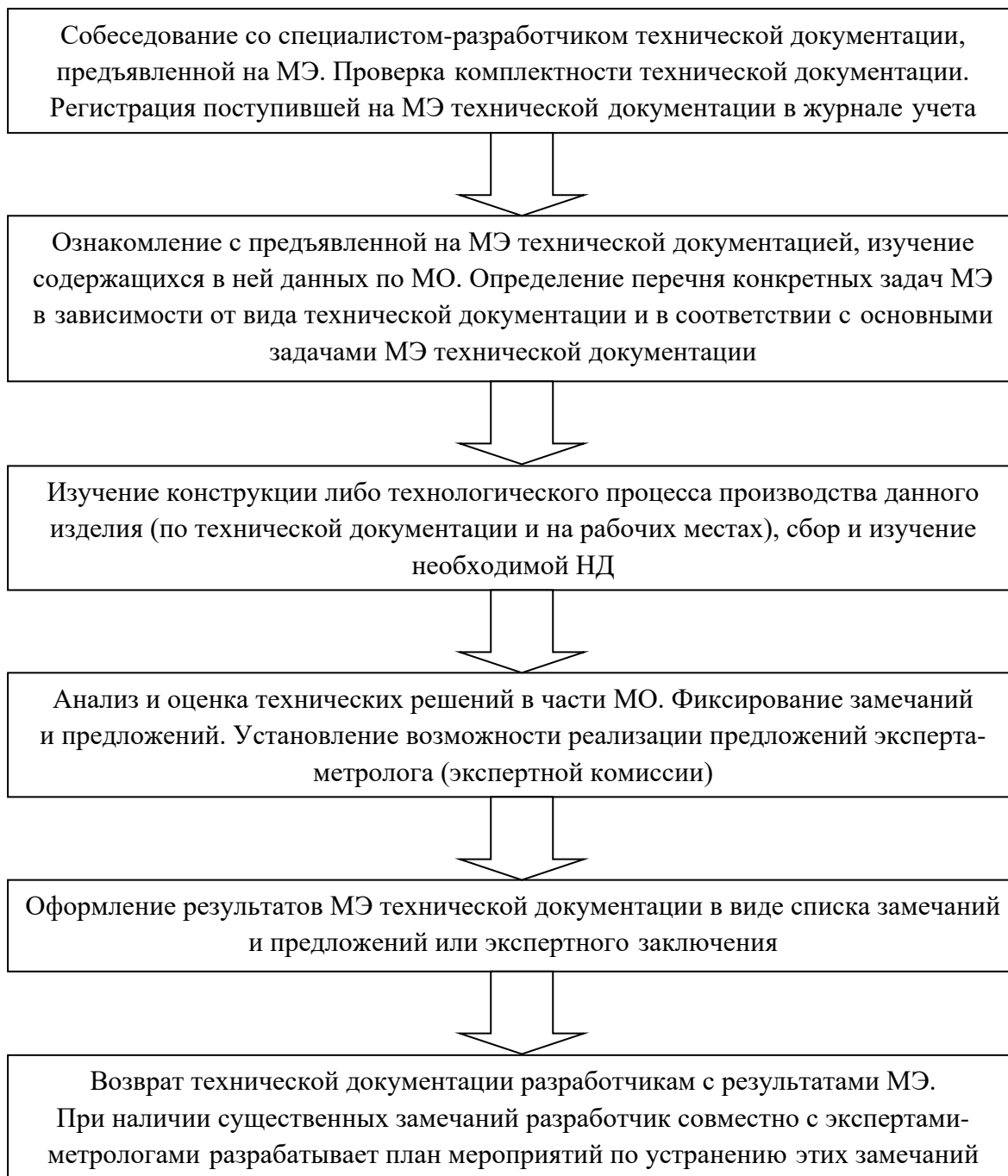
Рис. 2. Алгоритм проведения метрологической экспертизы
