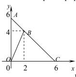
которое получается в результате вращения вокруг оси Ox треугольника OAB. Объём этого тела равен объёму конуса, образованного вращением отрезка AC (радиус основания r=6, высота h=6), минус объём конуса, образованного вращением отрезка BC (радиус основания r=4, высота h=4), минус объём конуса, образованного вращением отрезка OB (радиус основания r=4, высота h=2).
