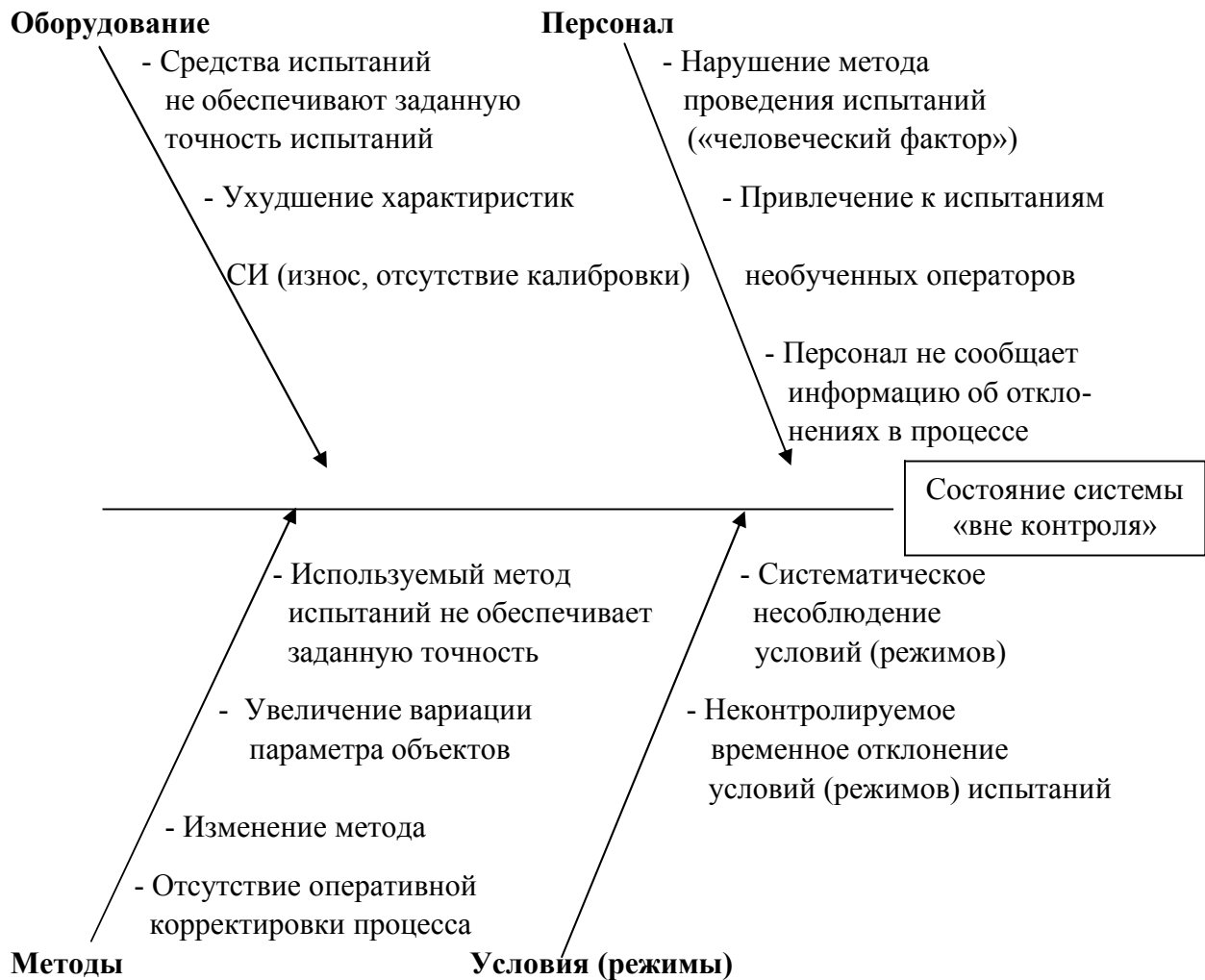
Рис. 7. Диаграмма причин и следствий для исследования нестабильности системы испытаний
