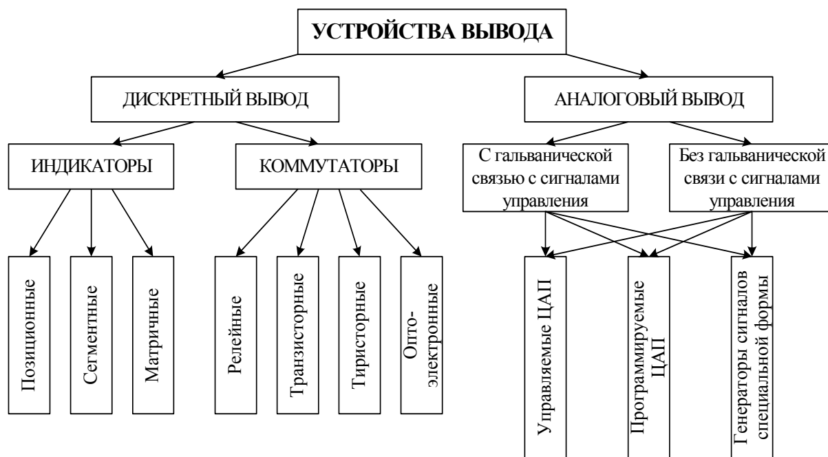
Рис. 4.1. Классификация устройств вывода
