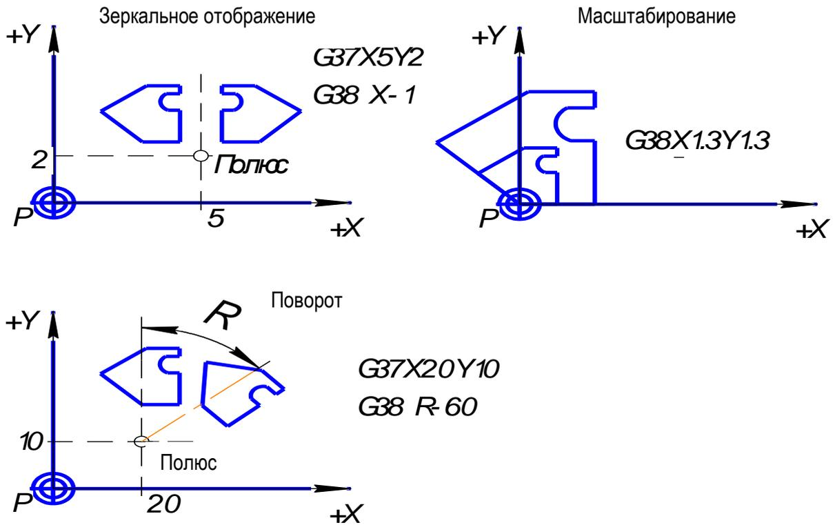
Рис. 26. Зеркальное отображение, масштабирование и поворот
