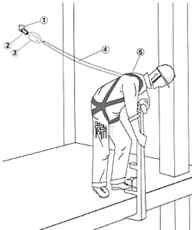
Рис. 18. Элементы страховочной системы: 1 – анкерная точка крепления; 2 – соединительный элемент (карабин); 3 – система ударопоглощения (амортизатор-демпфер); 4 – промежуточное соединение (строп, ограничитель падения); 5 – средства поддержки тела (лямочная привязь и пояс)
