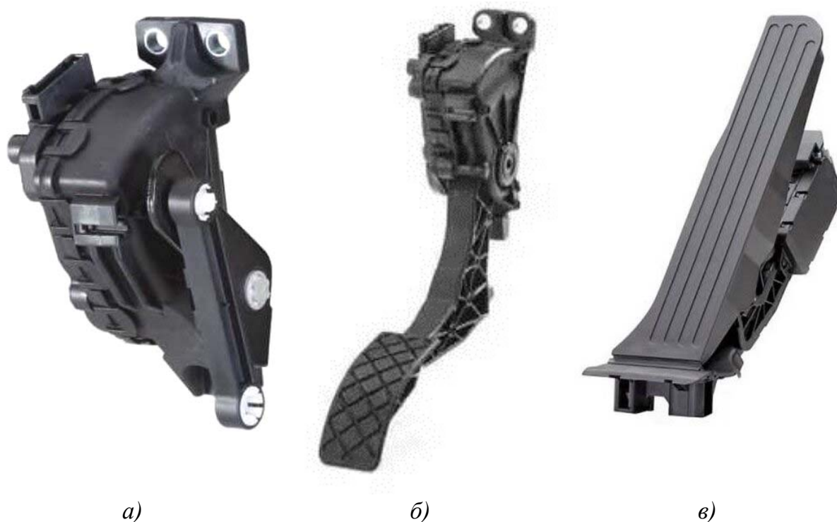
Рис. 2.55. Конструктивное исполнение датчиков педали акселератора: а – выносной; б – подвесной; в – с нижним креплением
