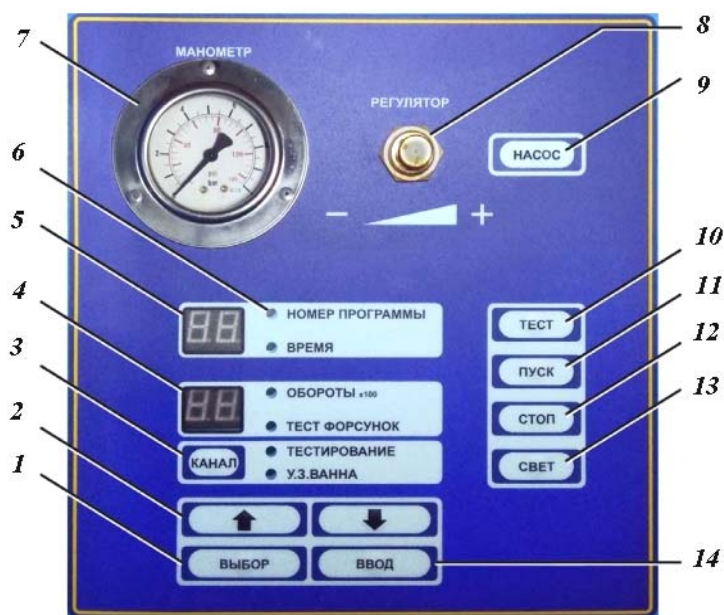
Рис. 2.72. Панель управления стенда SMC-3002E: 1 – кнопка выбора программ; 2 – кнопка перелистывания программ; 3 – кнопка выбора канала, по которому подается управляющий сигнал; 4 – индикатор частоты вращения и номера теста форсунок; 5 – индикатор времени тестирования и номера программы; 6 – светодиодные индикаторы состояния процесса; 7 – манометр; 8 – регулятор давления; 9 – кнопка включения/выключения насоса; 10 – кнопка запуска теста; 11 – кнопка запуска выбранной программы; 12 – кнопка сброса всех текущих процессов и программ; 13 – кнопка включения подсветки; 14 – кнопка ввода (подтверждения) программы
