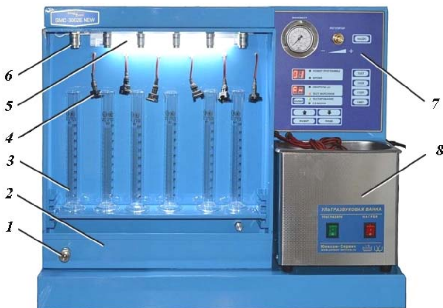
Рис. 2.71. Стенд для испытания и промывки форсунок SMC-3002E: 1 – обратный штуцер; 2 – бак для чистящей жидкости; 3 – мерные колбы; 4 – разъёмы подключения к форсункам; 5 – подсветка; 6 – быстроразъёмные соединения; 7 – панель управления; 8 – ванна ультразвуковой очистки форсунок
