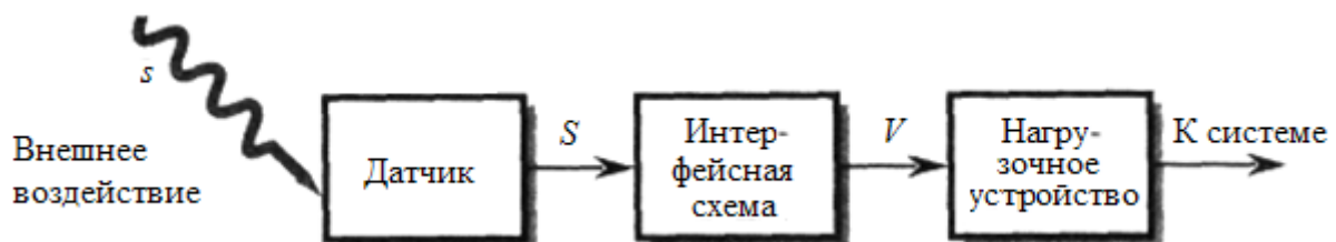
Рис. 6. Интерфейсная схема согласует форматы сигналов датчика и нагрузочного устройства
