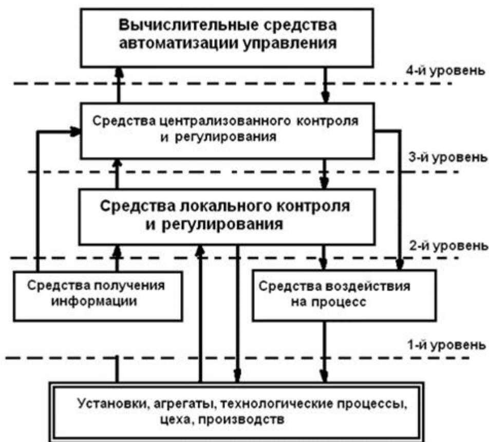
Рис. 1. Иерархическая структура технических средств ГСП
