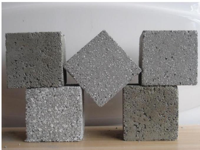
Рисунок 1. Образцы нанобетона
