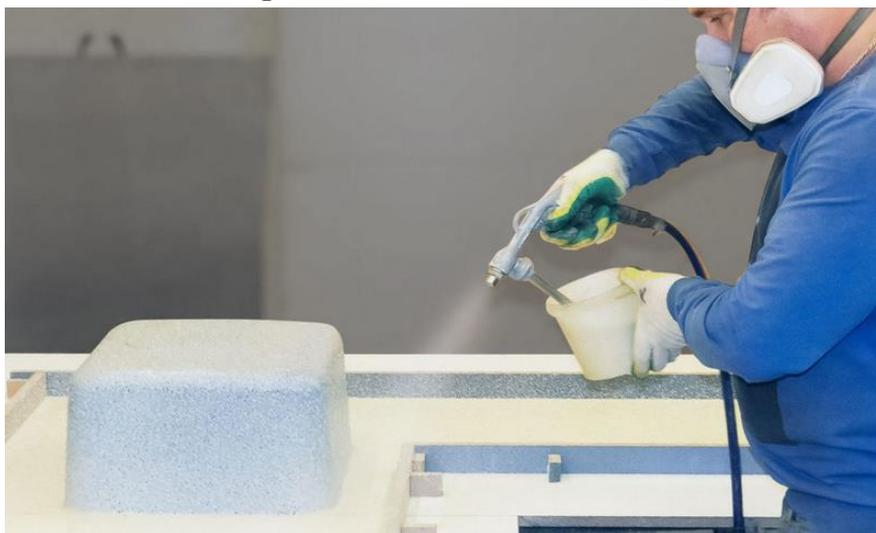
Рисунок 1. Напыление покрытия
