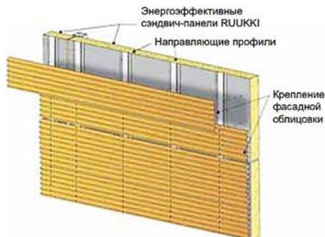
Рисунок 3. Фасадная система
