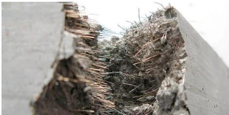
Рисунок 2. Виды волокон в фибробетоне
