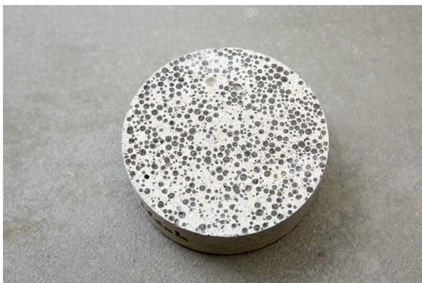
Рисунок 4. Образец самовосстанавливающегося бетона
