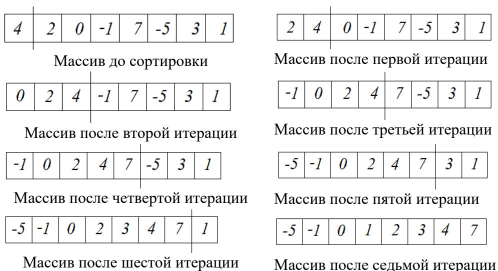
Рис. 36. Массив после итераций внешнего цикла алгоритма сортировки вставками
