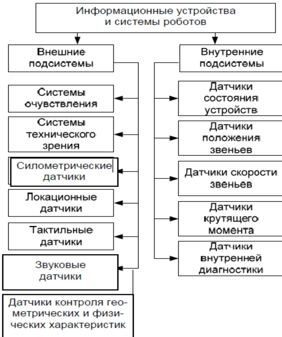
Рис. 1.27. Классификация информационных устройств и систем используемых в мехатронике и промышленных роботах
