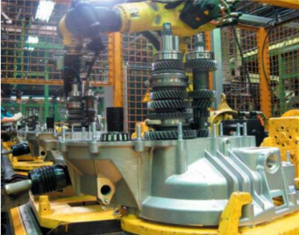
Рис. 1.45. РТК для нанесения жидкой прокладки на корпус картера сцепления
