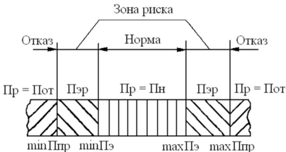
Рис. 4.10. Зоны работоспособности технической системы (объекта)
