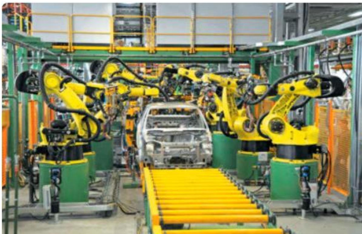
Рис. 1.43. Автоматическая линия контактной точечной сварки кузова
