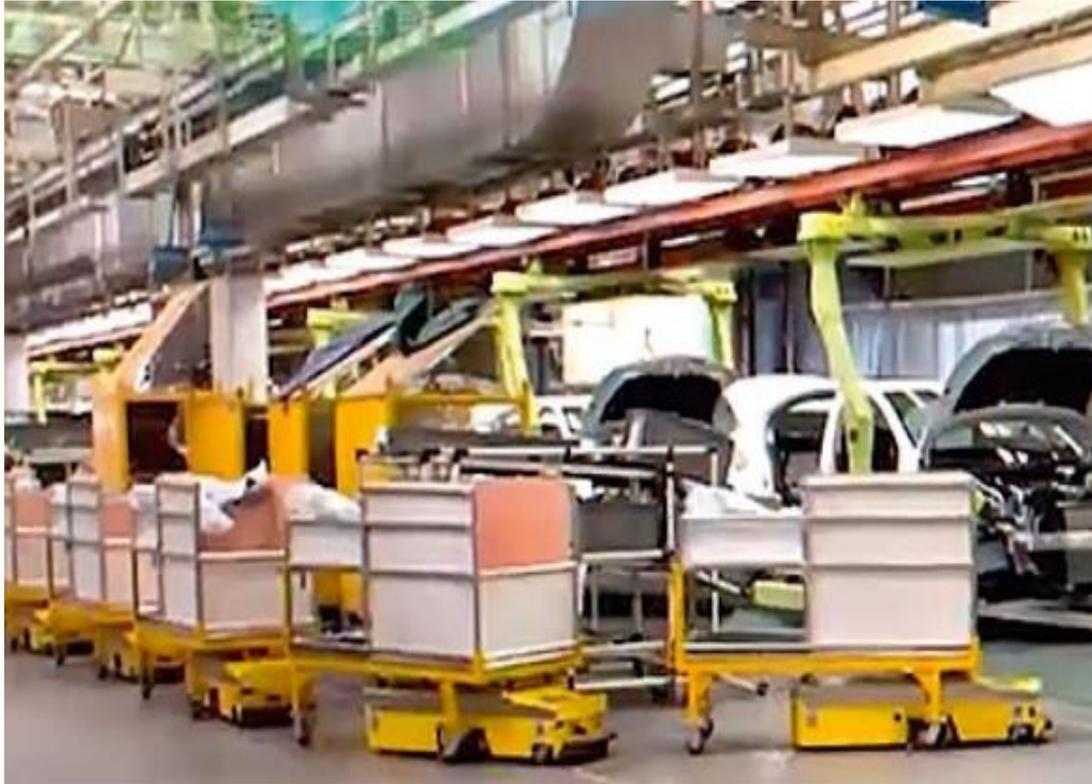
Рис. 5.3. Роботы-тягачи на линии сборки автомобилей
