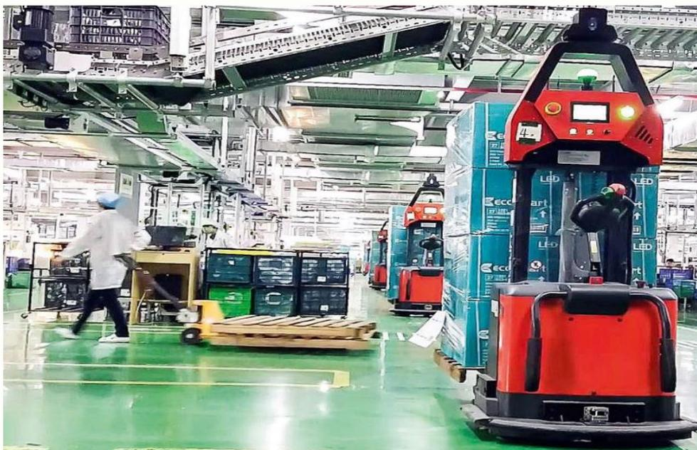
Рис. 5.5. Робот-погрузчик
