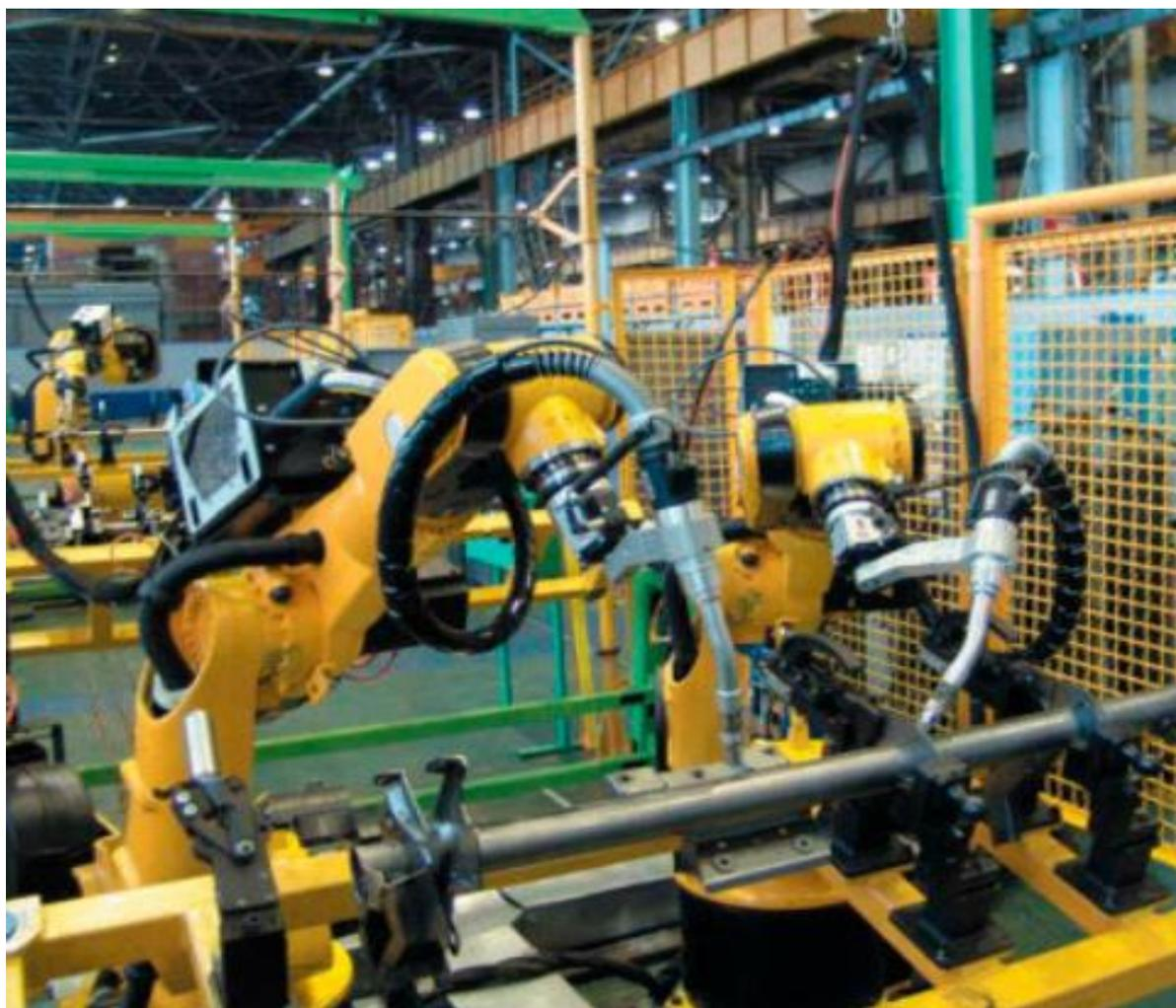
Рис. 1.42. Вид РТК дуговой сварки панели приборов
