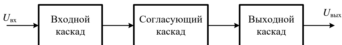
Рис. 4.2. Структурная схема трехкаскадного ОУ
