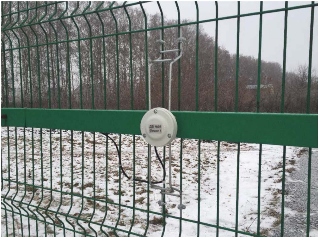
Рис. 2.8. Установка вибрационного извещателя
