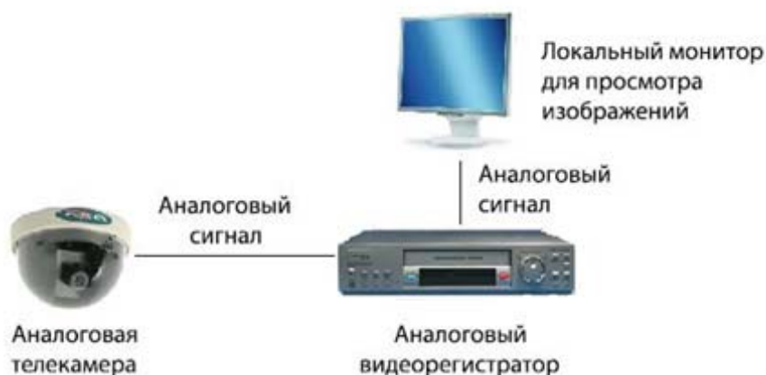
Рис. 4.1. Структурная схема системы видеонаблюдения на базе аналогового видеорегистратора
