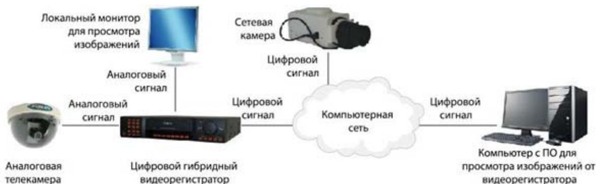
Рис. 4.2. Гибридная структурная схема системы видеонаблюдения на базе цифрового видеорегистратора
