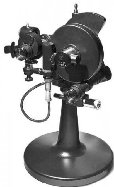
Рис. 65. Рефрактометр ИРФ-23 (типа Пульфриха)
