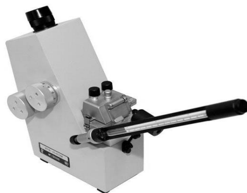
Рис. 62. Рефрактометр ИРФ-454-Б2М (типа Аббе)
