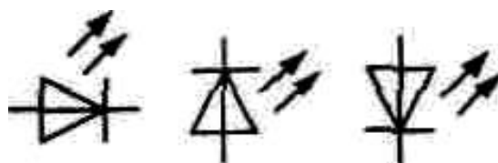
Рисунок 6.1 – Условное графическое изображение светодиода
