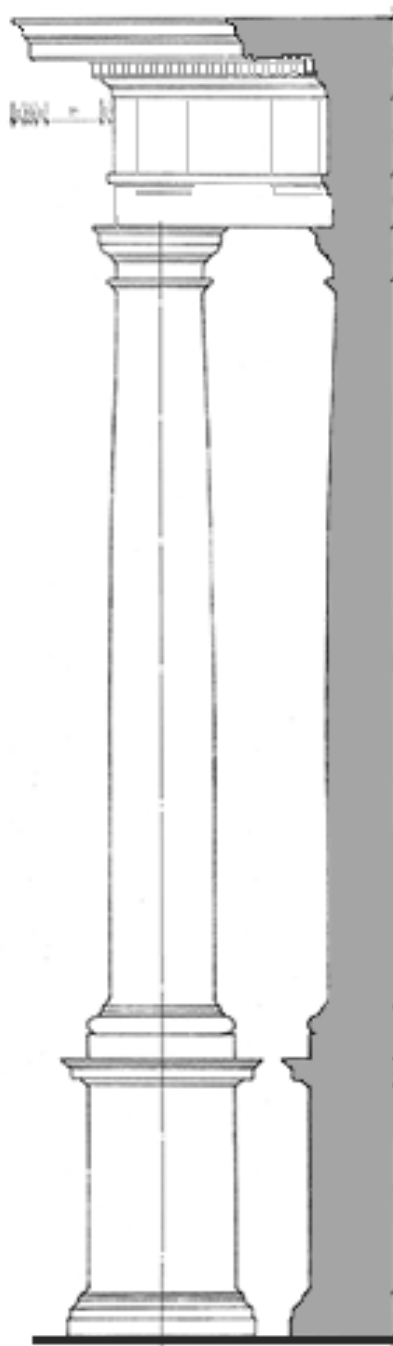
Рис. 43. Дорический зубчатый ордер
