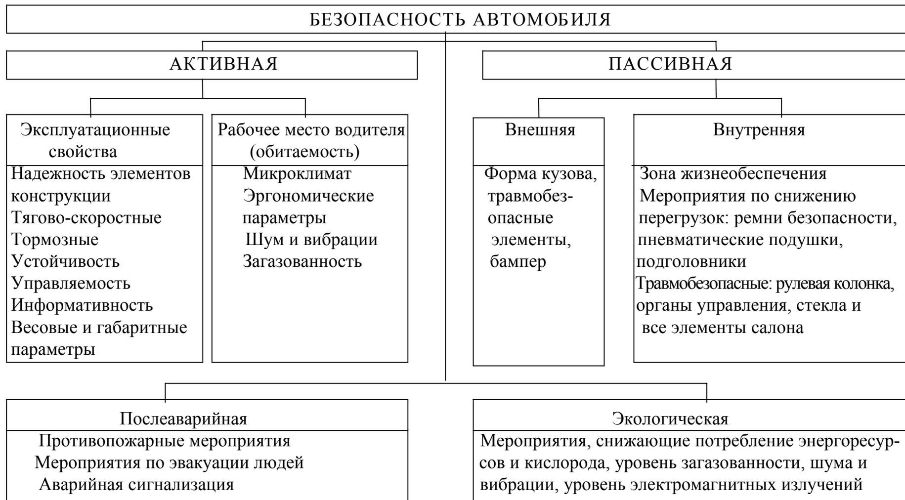
**Рис. 9. Структура безопасности автомобиля**
