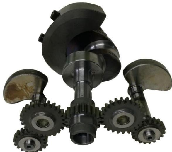
**Рис. 5. Механизм уравнивания**
