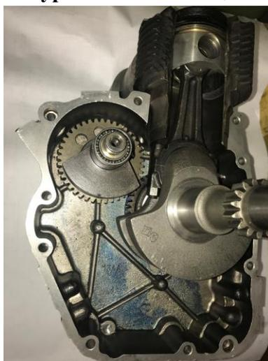
Рис. 2. Механизм уравнивания дизеля ТМЗ-650Д
