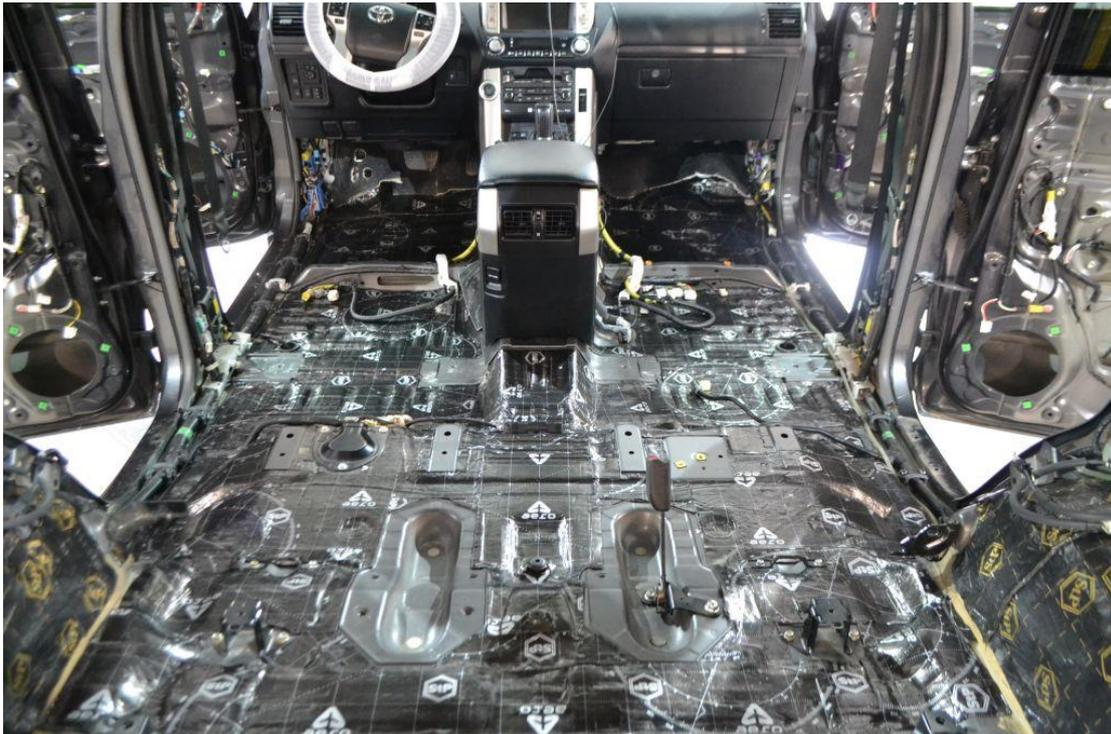
**Рис. 1. Установка вибропоглощающего материала на кузов автомобиля**
