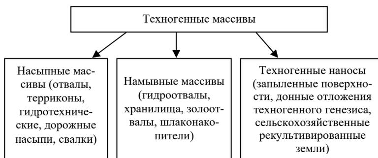
Рис. 5.2 Классификация техногенных массивов
