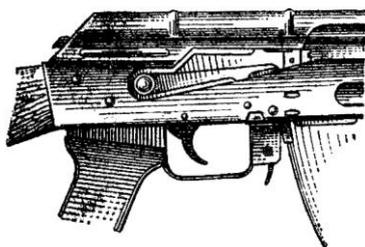
Рис. П4.7. Автомат (пулемет) поставлен на предохранитель
