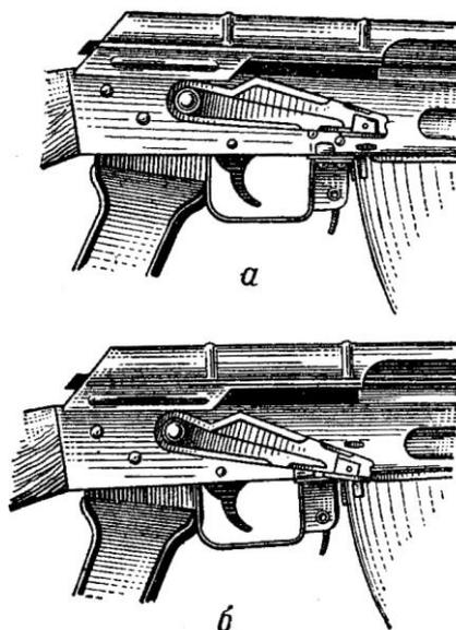
Рис. П4.13. Установка переводчика на необходимый вид огня: а – для ведения автоматического огня; б – для ведения одиночного огня
