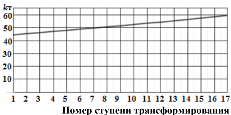
Рис. 77. График зависимости изменения коэффициента трансформации трансформатора TV1 от номера ступени переключения
