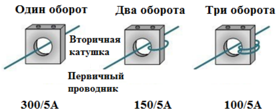
Рис. 42. Примеры изменения коэффициента трансформации токов числом проходов первичного проводника через окно магнитопровода
