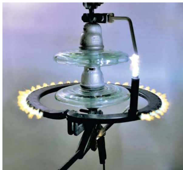
Рис. 60. Общий вид разрядника мультикамерного экранного типа РМКЭ-20 и фото его срабатывания: 1 – разрядный элемент; 2 – отводящий электрод; 3 – узел крепления отводящего электрода к изолятору; 4 – электрод-индикатор
