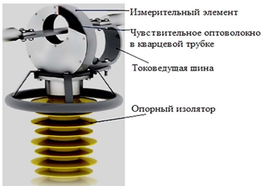
Рис. 50. Конструктивное исполнение волоконно-оптического датчика тока
