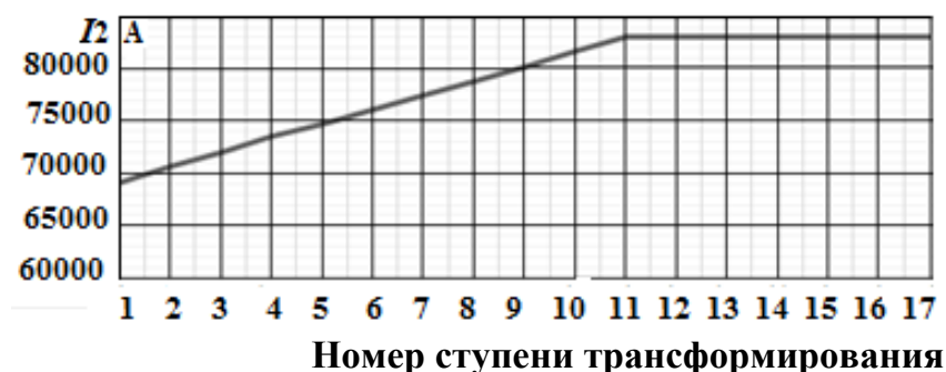
Рис. 79. График зависимости действующего значения тока вторичной обмотки TV1 от номера ступени переключения
