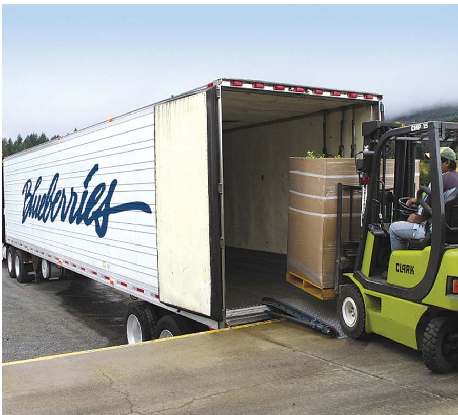
Рис. 9. Погрузка с использованием горизонтальной площадки
