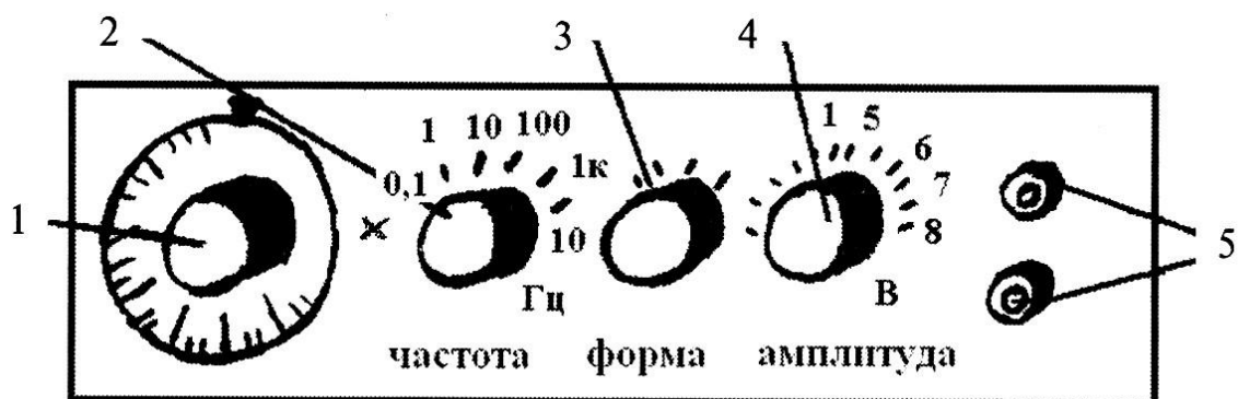
Рис.3. Генератор ФГ -100 (лицевая панель): 1-рукоятка регулирования частоты; 2- переключатель диапазона частот; 3- рукоятка регулирования выходного сигнала; 4- рукоятка регулирования выходного напряжения; 5- гнезда для подключения нагрузки к генератору.
