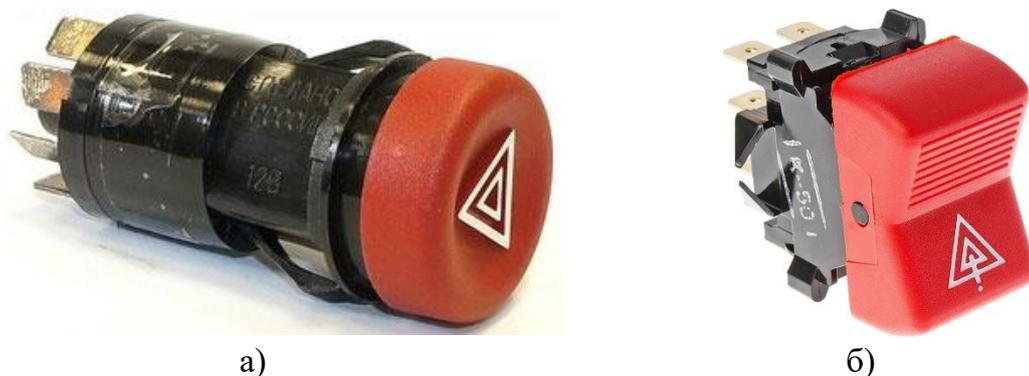
Рис. 12.9. Типы выключателей аварийной сигнализации:
