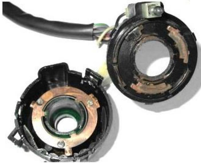
Рис. 12.6. Внешний вид контактов замка зажигания
