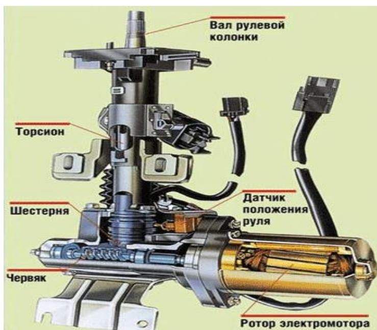
Рис. 4.26. Схема привод с червячной передачей на рулевом валу
