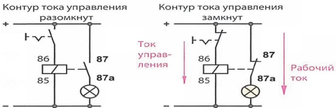
Рис. 12.21. Схема реле с замыкающими контактами
