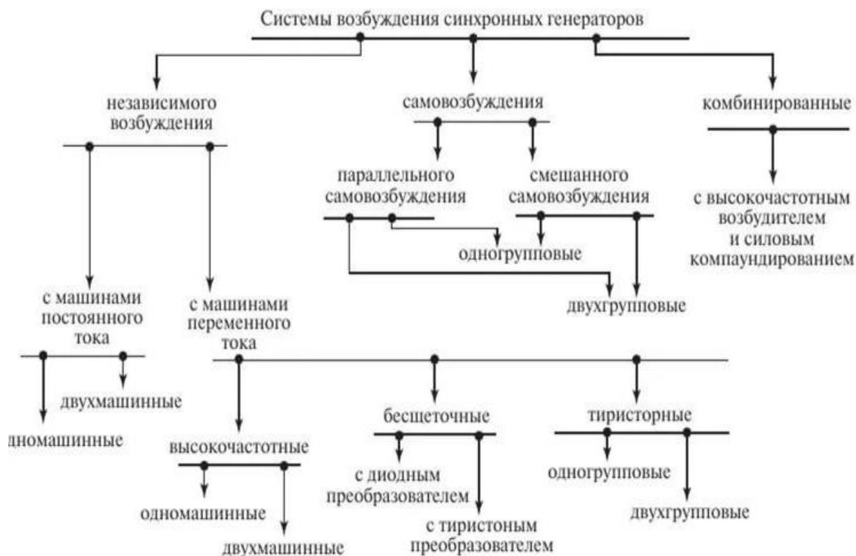
Рис. 5.18. Классификация систем возбуждения синхронных генераторов
