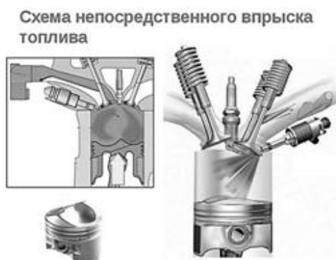
Рис.16. Конструктивные изменения при непосредственном впрыске бензина.
