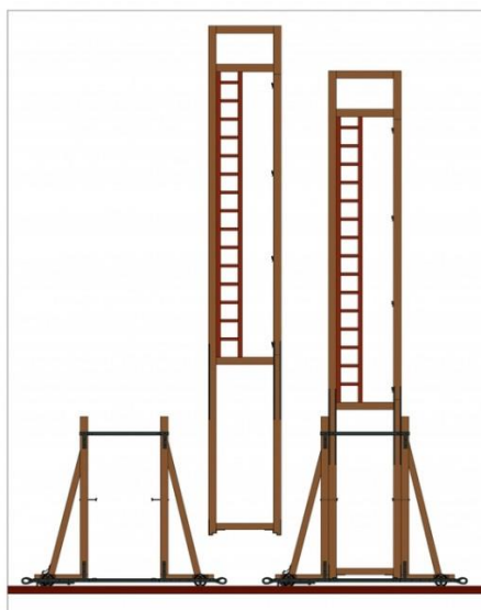
Ил. 28. Кулисная машина. заряжается сменными рамами, на которых имеется декорационное оформление сцены
