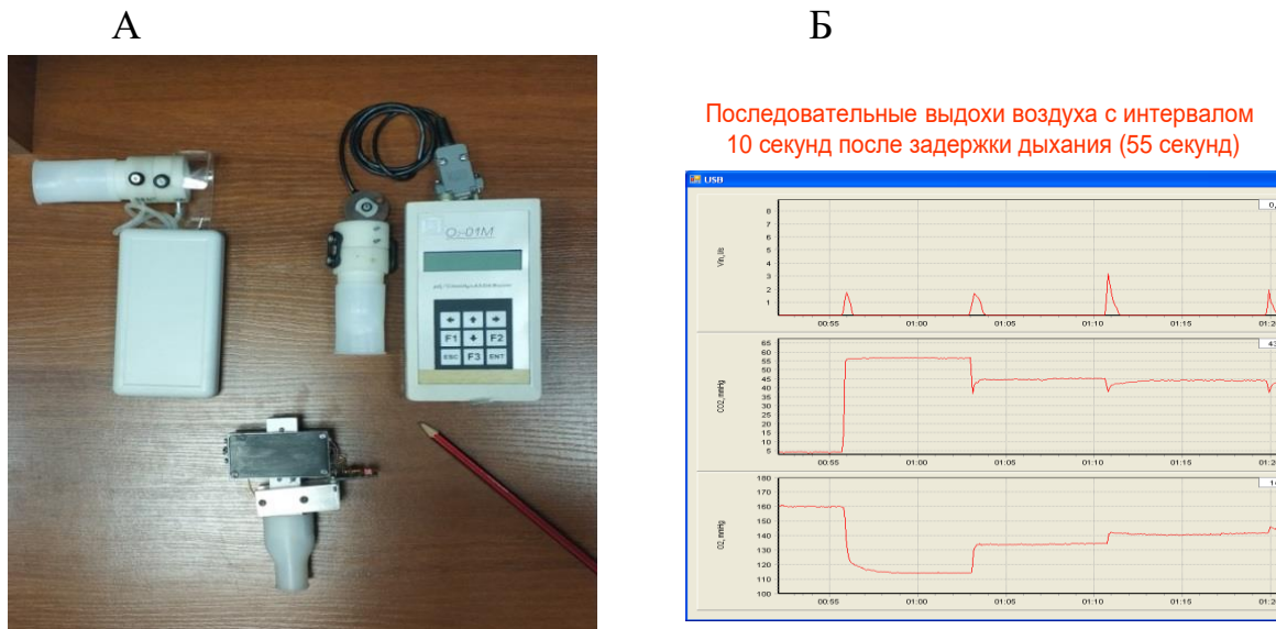
Рис. 2. Аналитический комплекс в составе анализаторов объемной скорости дыхания, парциальных давлений O_2 и CO_2 в выдыхаемом воздухе (А). Позволяет регистрировать динамику дыхания и газообмена (Б)
