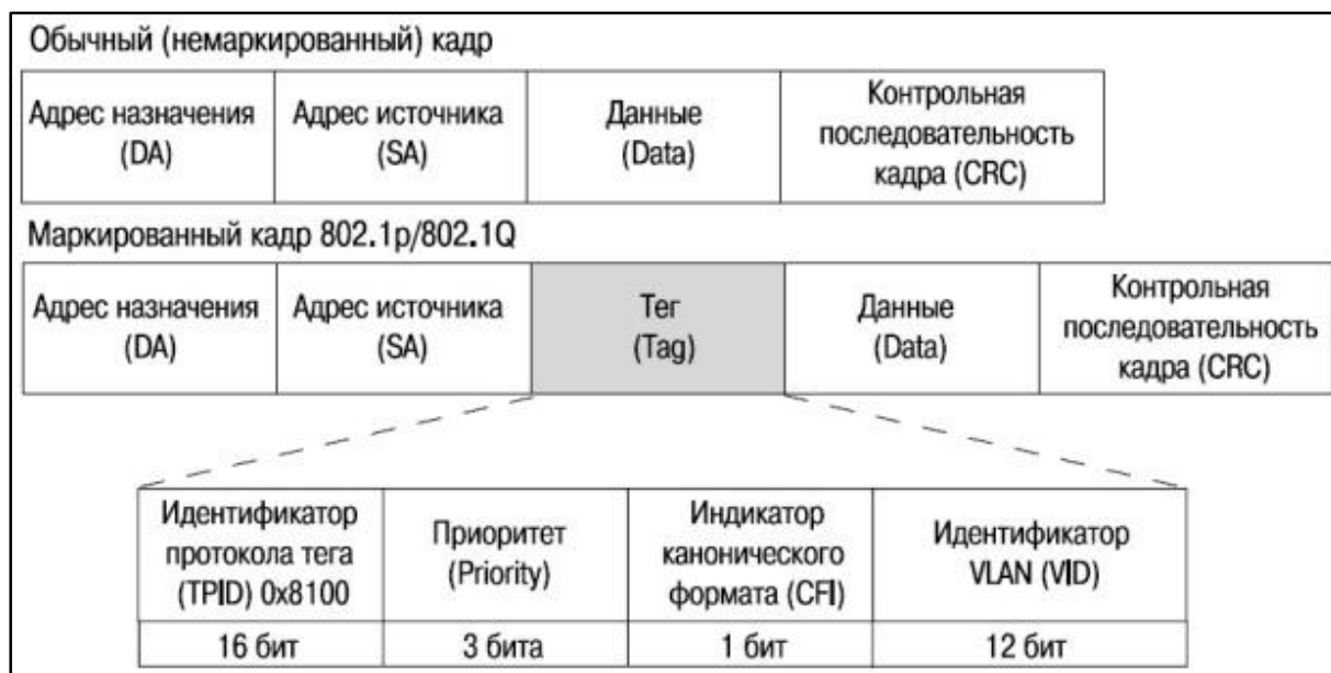
Рисунок 5.3 - Формат тега 802.1Q VLAN Ethernet
