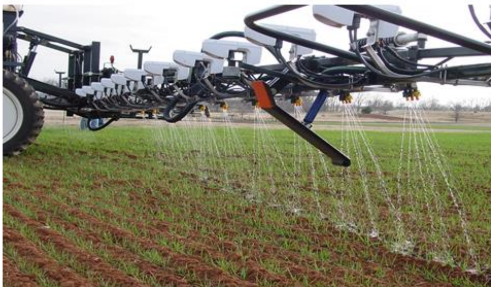
Рис. 20. Дифференцированное внесение жидких азотных удобрений
