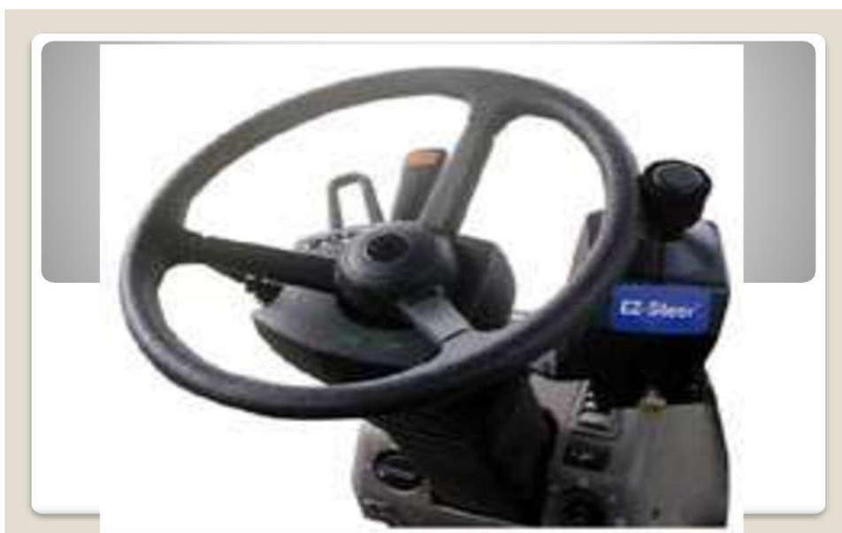
Рис. 13. Использование подруливающего устройства EZ-Steer
