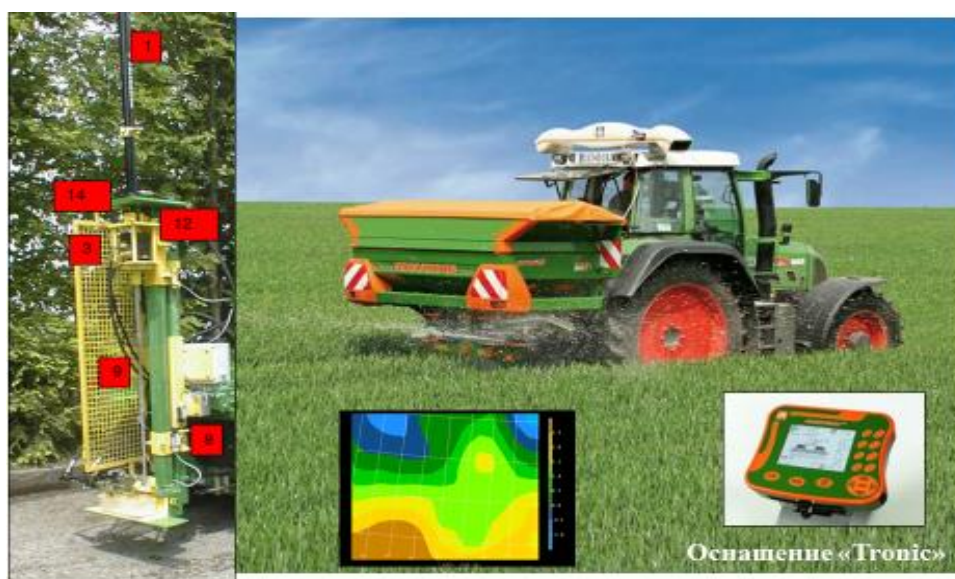
Рис. 10. Дифференцированная подкормка озимой пшеницы азотом разбрасывателем удобрений AMAZONE ZA-M 900
