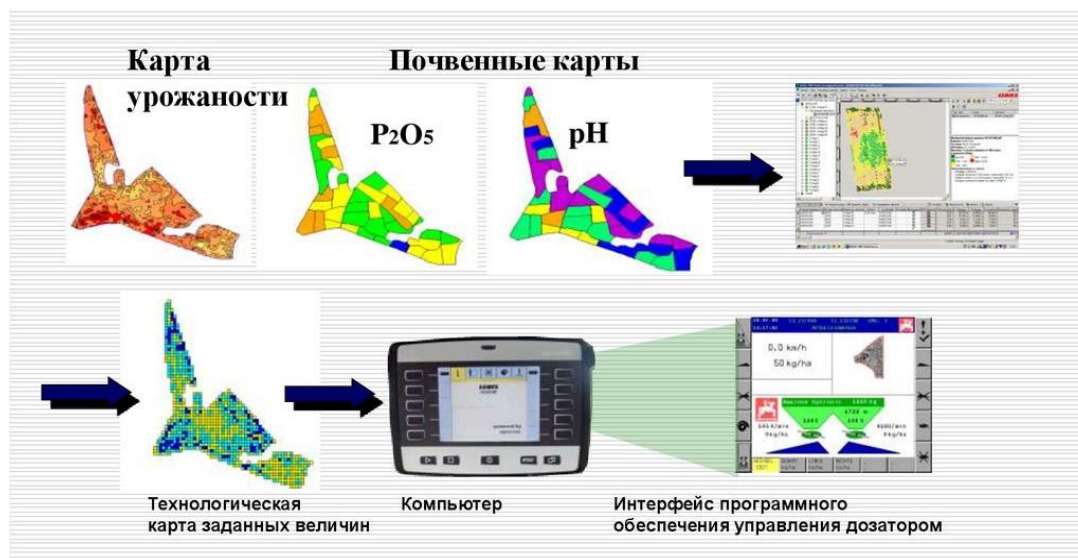
Рис. 16. Составление технологической карты для управления дозированием («off-line»)
