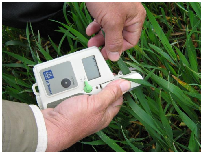
Рис. 19. Диагностика азотного питания озимой пшеницы N-тестером фирмы «Yara»
