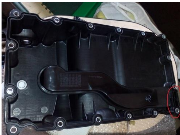
Рис. 3. Соединение маслозаборника с масляным насосом
