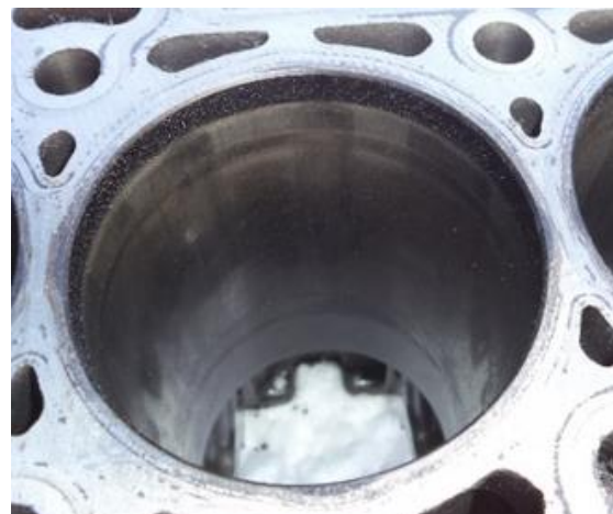
Рис. 2. Задир зеркала цилиндра
