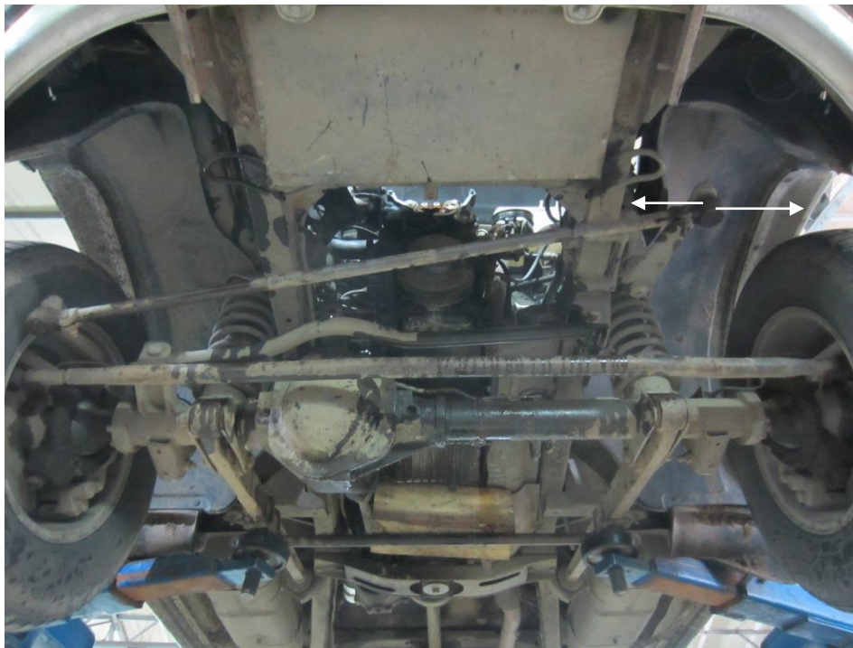
Рис. 5. Передняя подвеска и рулевая трапеция автомобилей УАЗ Патриот. Белые стрелки показывают направление усилий приложенных от колёс к сошке в эксплуатации
