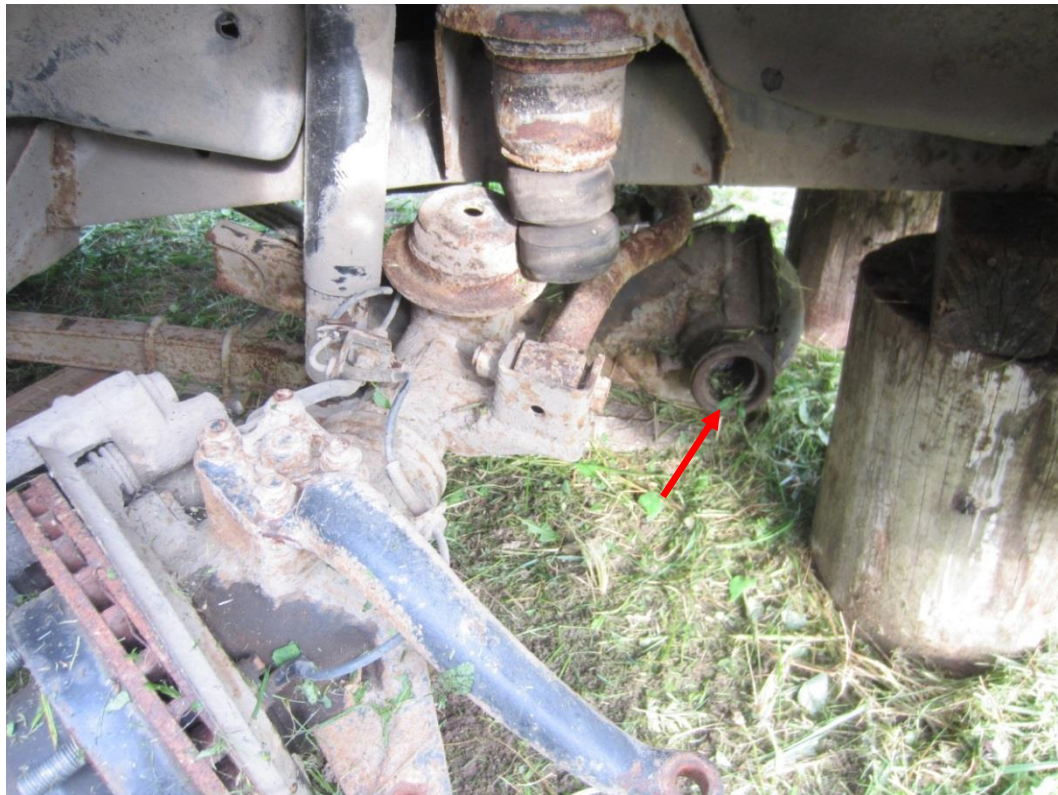
Рис. 1. Балка переднего моста и рычагов подвески с правой стороны автомобиля (пружины и рулевые тяги демонтированы)
