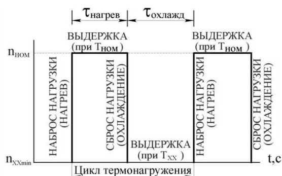
Рис. 1. Схематичное изображение цикла нагружения головки цилиндров транспортного дизеля
