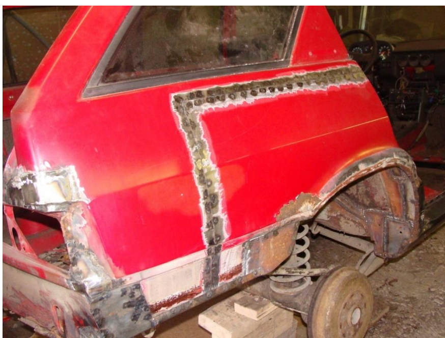
Рис. 2. Пример установки ремонтных вставок на заднюю правую боковину автомобиля ВАЗ-2108
