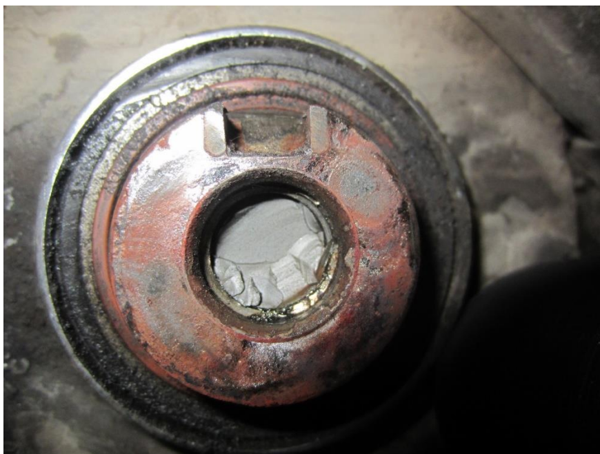
Рис. 4. Поверхность торца коленчатого вала исследуемого двигателя. Внутри резьбового отверстия виден остаток болта
