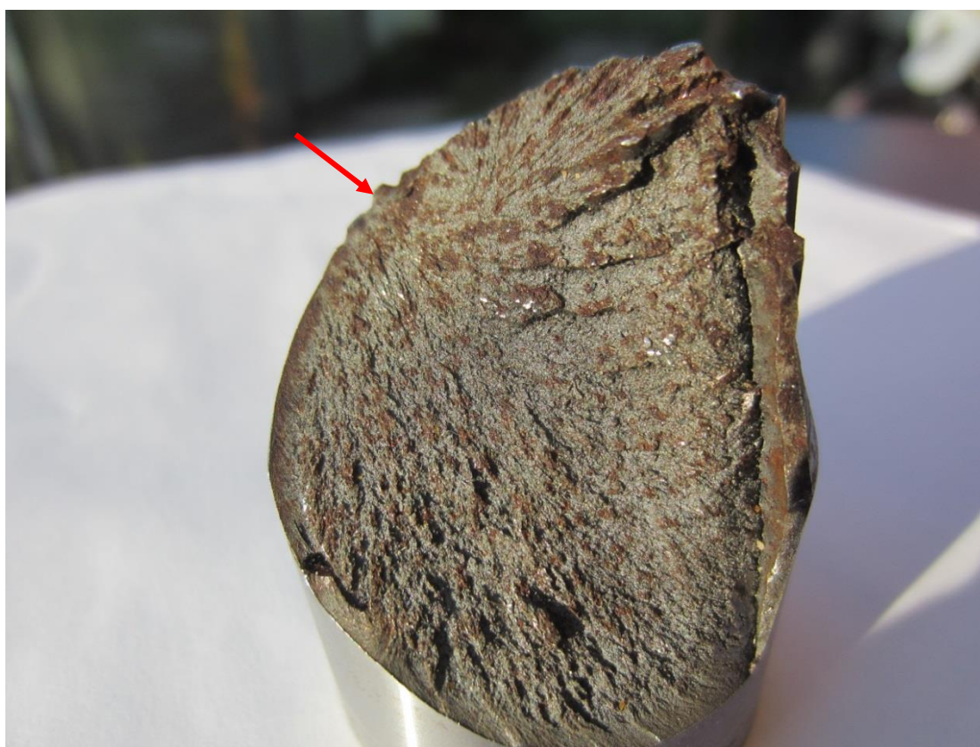
Рис. 3. Поверхность излома вала сошки представленного на исследование. Стрелкой указан очаг разрушения
