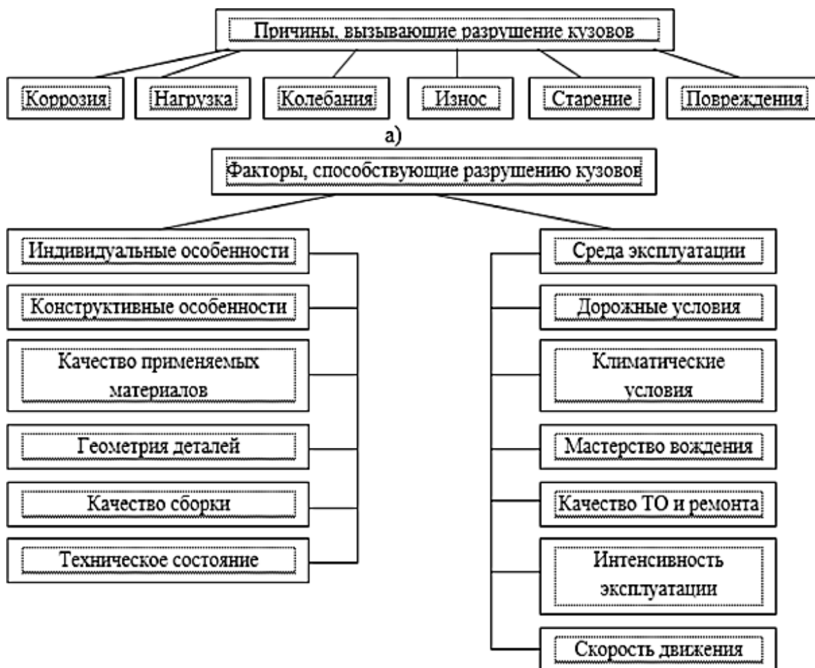
Рис. 1. Причины, вызывающие разрушения кузова ТС
