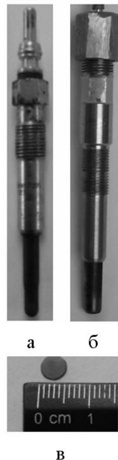
Рис. 2. Штатная свеча накаливания (а), малогабаритный датчик давления (б) и диафрагма (в)
