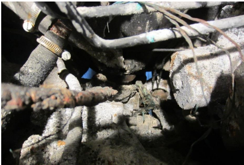
Рис. 2. Расположение участка жгута проводки к усилителю рулевого управления, где произошло расплавление провода электроусилителя
