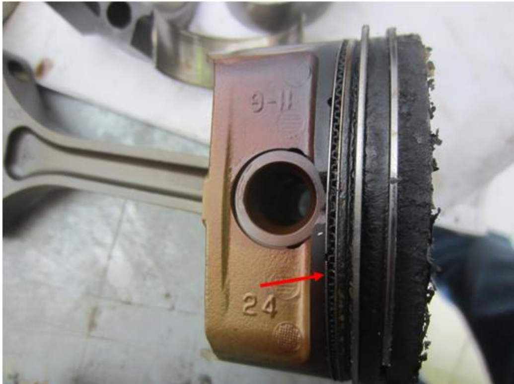
Рис. 1. Вид сбоку на поршень второго цилиндра. Маслосъёмные кольца потеряли подвижность, «залегли»
