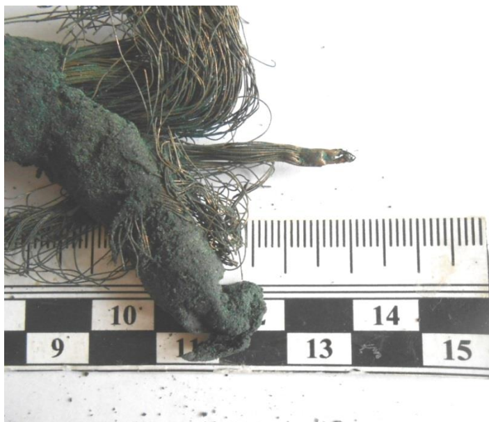
Рис. 3. Внешний вид оплавившегося провода электроусилителя
