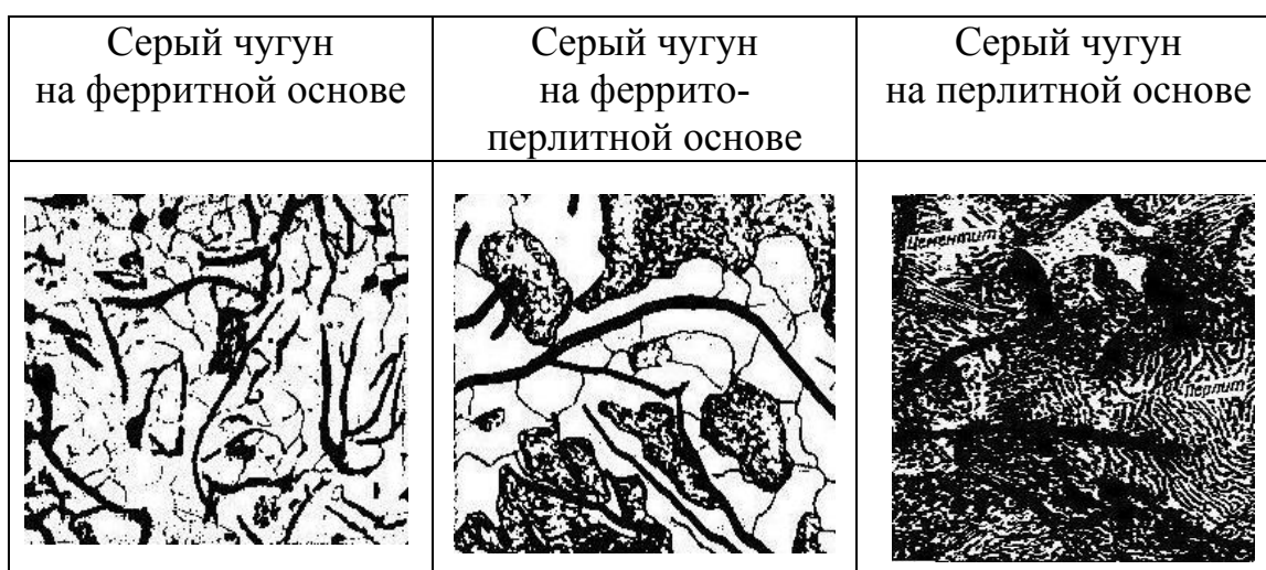
Рис.12.3. Микроструктуры серых чугунов
