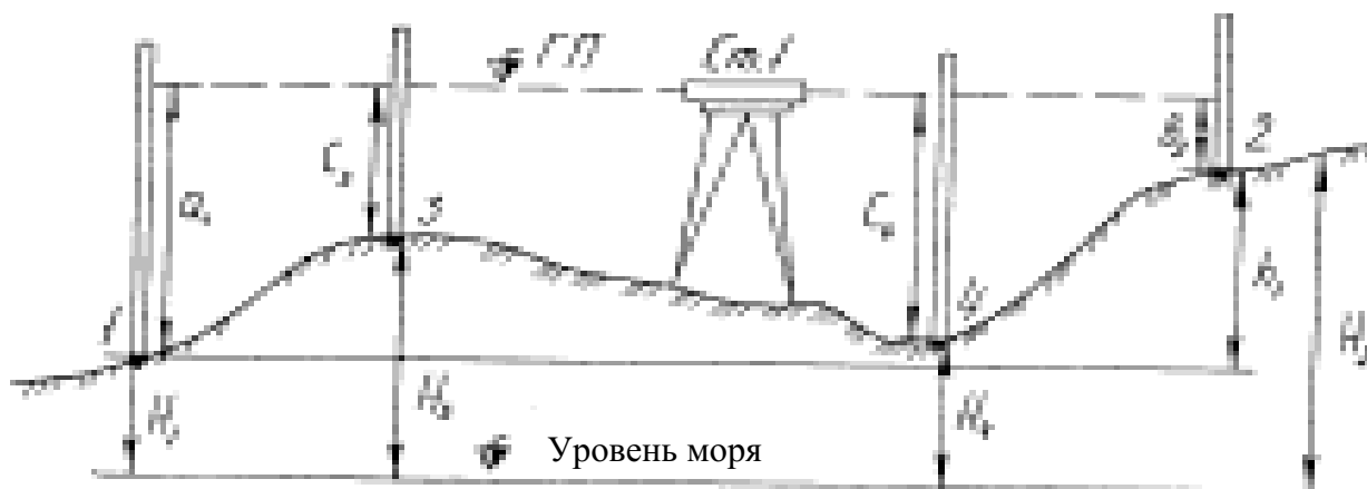
Рис. 13. Схема нивелирования на станции
