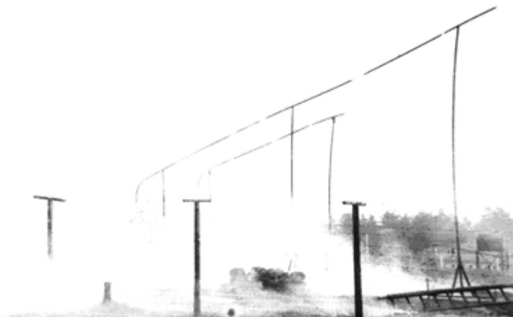
Рис. 42. Горелки (плети) ТУМВ через 1 час работы на номинальном режиме (100 атм). Установившаяся циркуляция вектора скорости воздуха «разрывает» сплошность факела пламени. Горение происходит при подавляющем избытке окислителя (рис. 39 в). Обнаружены деформации штативов под действием термической нагрузки. Необходимо их защитить постановкой защитных экранов на верхние части
