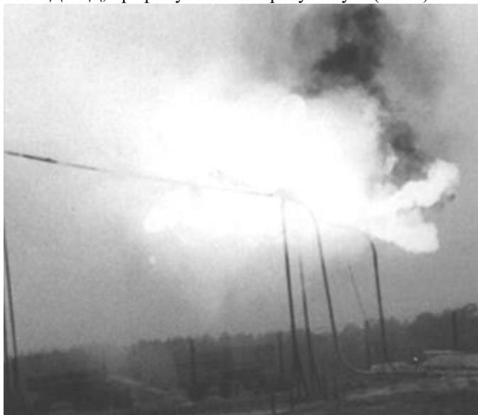
Рис. 39. Испытания форсунок ТУМV 15.05.80. Давление подачи топлива 100 атм. Реакция форсуночного узла № 1 на входе в плетть на поджиг от факела и распределение форсуночных факелов на узле для эффективного поджига облака. Другие форсуночные узлы заглушены
