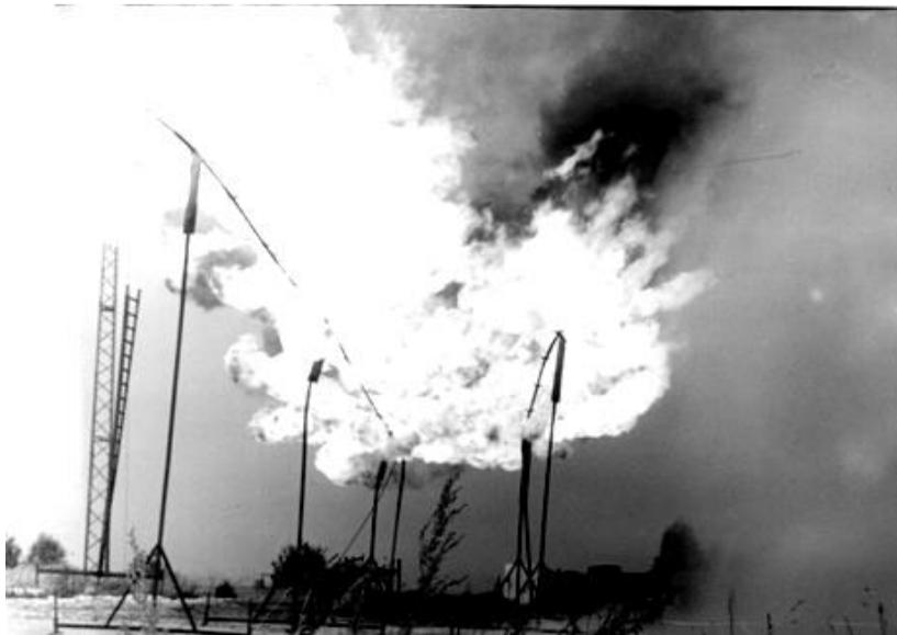
Рис. 50. Работа ТУМВ (100 атм) (21.09.82.) Поиск «лепестка» направленности акустического излучения в предполагаемом фокусе пламени
