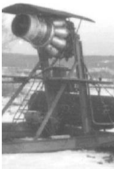
Рис. 5. Фото ТРД типа ВКІА в рабочем состоянии эксплуатации с емкостью (на заднем плане) для топлива ТС-1
