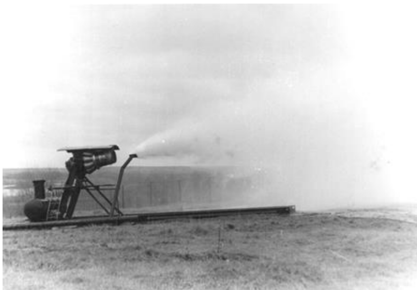
Рис. 37. Компьютерная версия фотографии распылительной части (1 – 4 по рис. 1) при работе системы генерации водного аэрозоля в нагретой струе ТРД при оптимальной ориентации 50^\circ насадка разбрызгивателя относительно оси сопла. Номинальный режим работы ТРД: 8000 об/мин, средняя начальная скорость – 400 м/с, температура продуктов сгорания на срезе сопла 600^\circ\text{C} . Расход воды – 100 л/с, максимальная дальность – 68 м [147]
