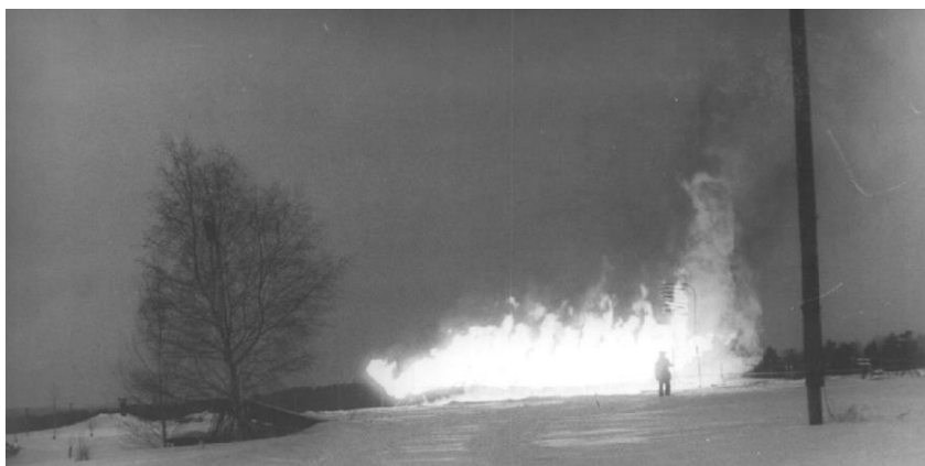
Рис. 14. Компьютерная версия работы метеотрона IV (7.02.80) [1]. Метеоусловия: тихо, пасмурно, перед снегопадом. На расстоянии 20 м от кромки пламени и в его проекции находится наблюдатель (масштабная единица) качества перемешивания и горения в объеме пламени
