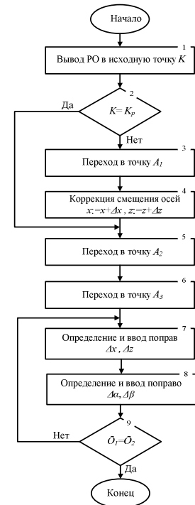
Рисунок 6 - Блок-схема алгоритма согласования осей
