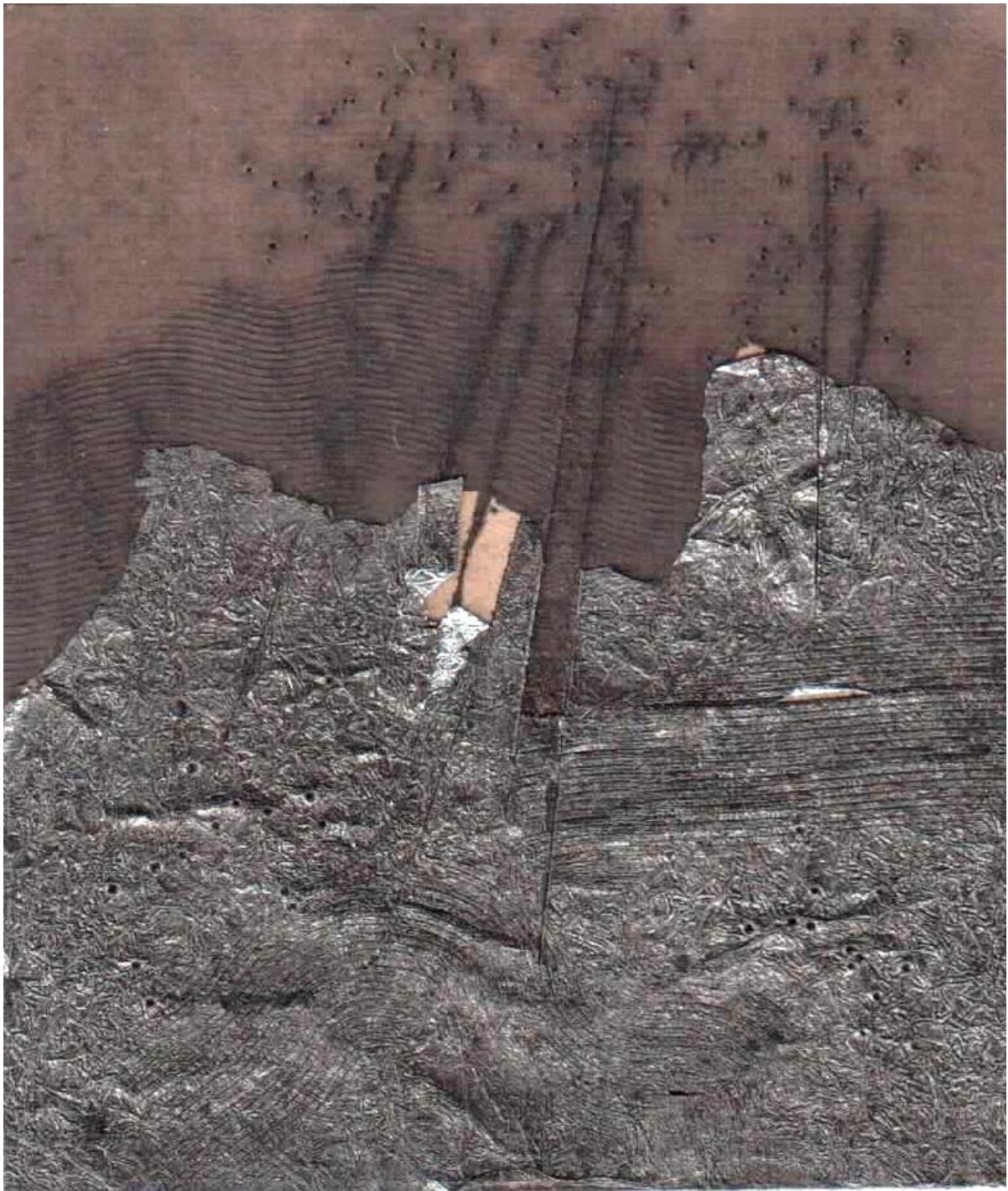
Печатная форма (основа – изоляционный картон; фольга)
