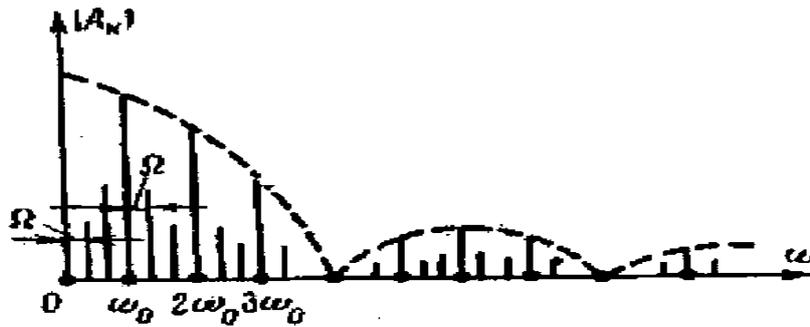
Рис.4.12. Спектр АИМ-сигнала
