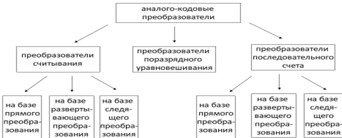
Рис. 3.7. Классификация основных типов аналого-кодовых преобразователей
