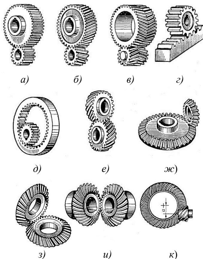
Рис. 180. Виды зубчатых передач: а, б, в – цилиндрические с внешним зацеплением; г – реечная; д – цилиндрическая с внутренним зацеплением; е – зубчатая винтовая; ж, з, и – конические зубчатые; к – гипоидная
