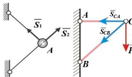
Рис. 6. Стержневая связь
