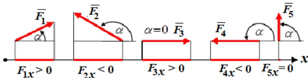
Рис. 18. Проекция силы на ось
