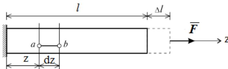
Рис. 124. Нагруженный стержень силой  $F$
