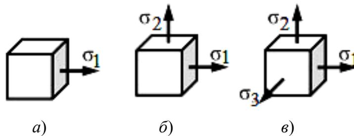
Рис. 121. Виды напряжённого состояния: а – линейное (одноосное); б – плоское (двухосное); в – объёмное (трёхосное)
