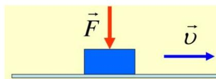
Рис. 95. Нулевая работа
