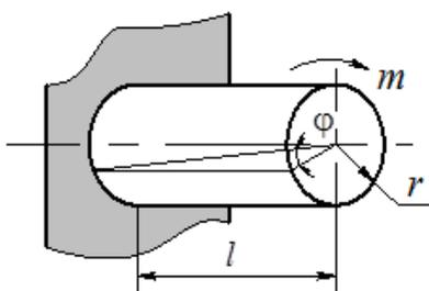
Рис. 136. Определение угла закручивания
