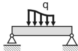
Рис. 116. Распределённая нагрузка
