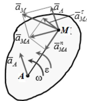
Рис. 73. Сложение ускорений точки  $M$
