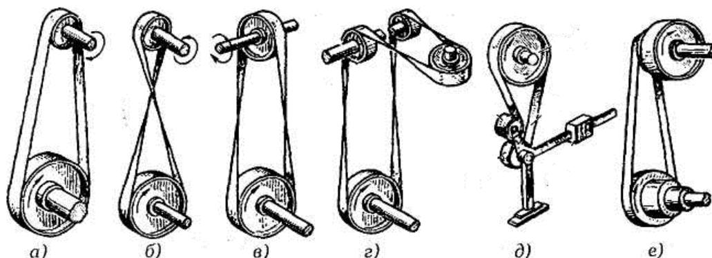
Рис. 178. Виды ременных передач: а – открытая; б – перекрёстная; в – полуперекрёстная (со скрещающимися валами); г – угловая с направляющим роликом; д – с нажимным роликом; е – со ступенчатым шкивом
