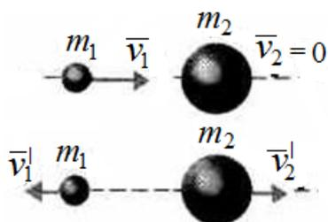
Рис. 108. Движение тел при абсолютно упругом ударе
