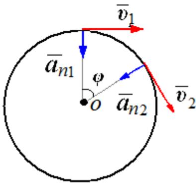
Рис. 63. Равномерное движение точки по окружности
