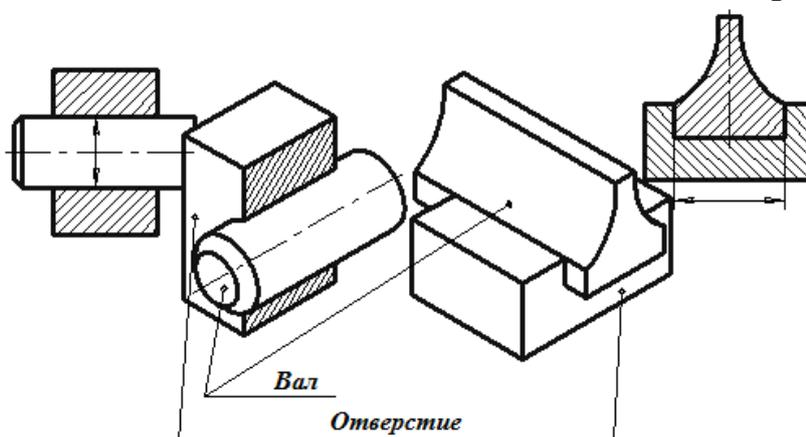
Рис. 172. Соединение двух деталей
