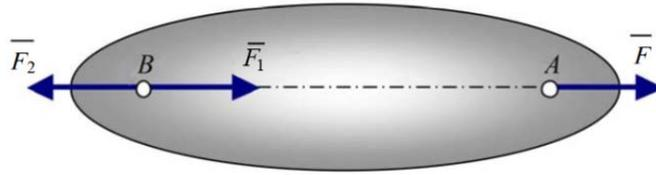
Рис. 13. Равновесие твёрдого тела
