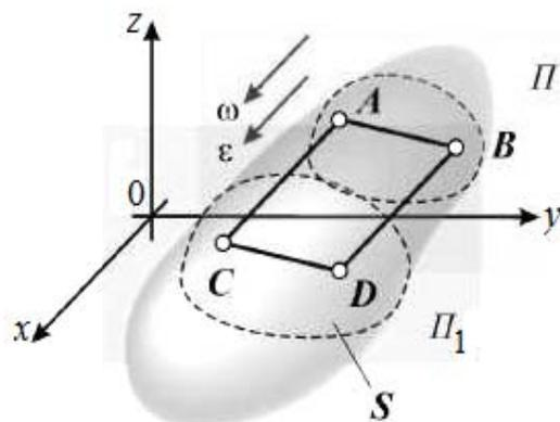
Рис. 66. Плоское движение твёрдого тела
