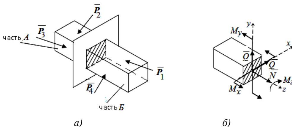
Рис. 119. Метод сечения РОЗУ: а – система сил;
