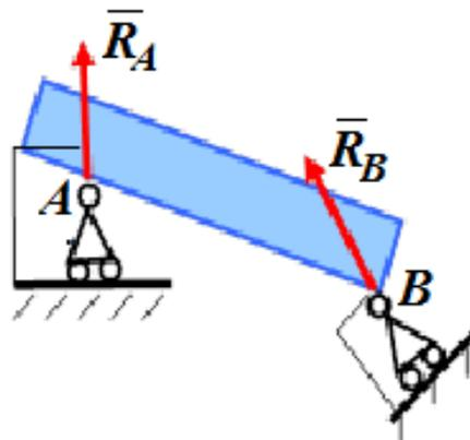
Рис. 9. Шарнирно-подвижная опора
