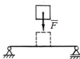
Рис. 118. Ударная нагрузка
