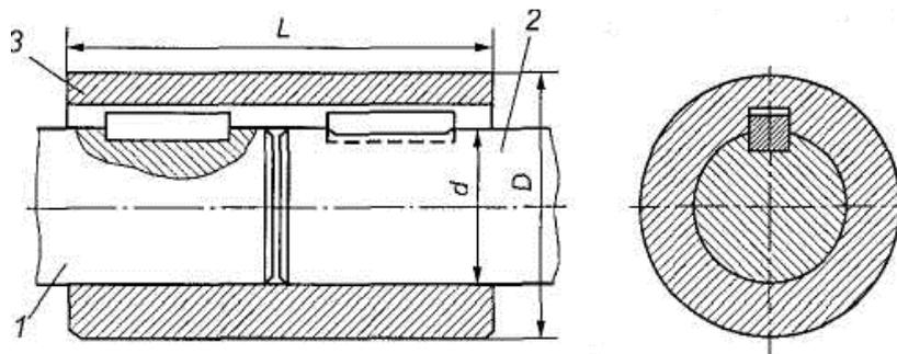
Рис. 194. Втулочная муфта с креплением на шпонках
