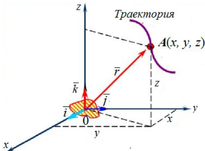
Рис. 56. Координатный способ
