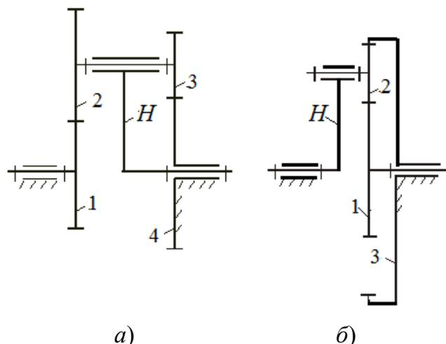
Рис. 159. Кинематические схемы планетарных механизмов
