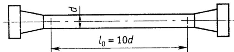
Рис. 125. Образец для испытания
