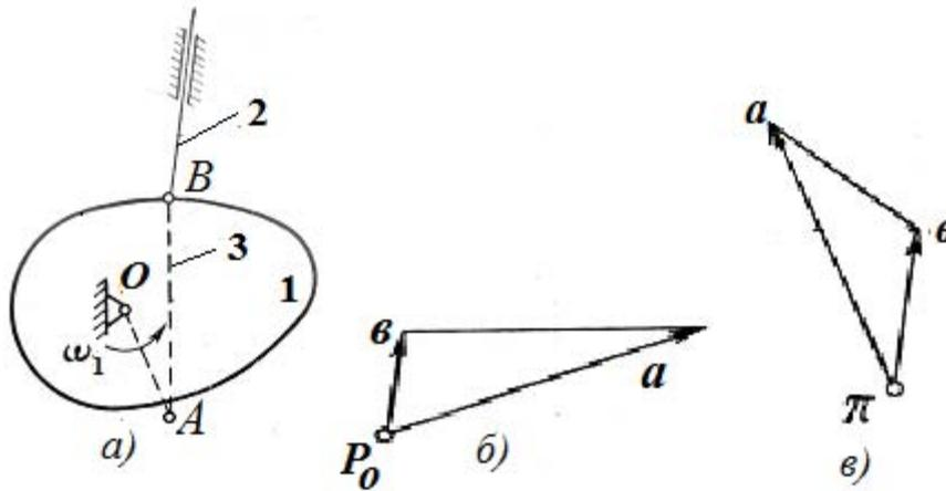
Рис. 166. Кулачковый механизм (графический метод)
