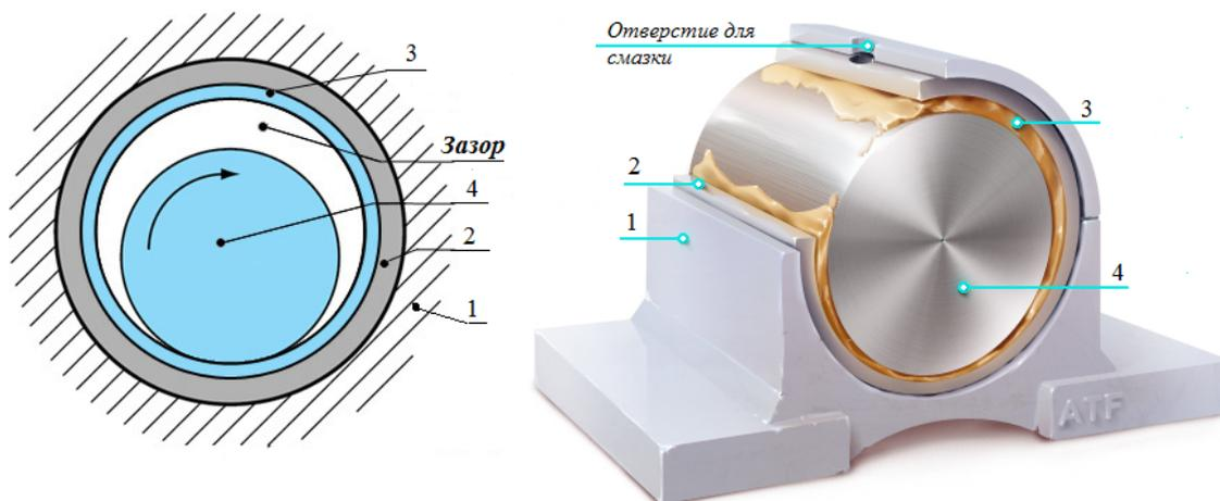
Рис. 191. Схема и общий вид подшипника скольжения
