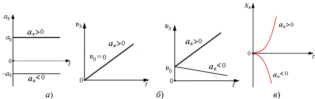
Рис. 62. Графики зависимости: а – ускорения от времени; б – скорости от времени; в – перемещения от времени
