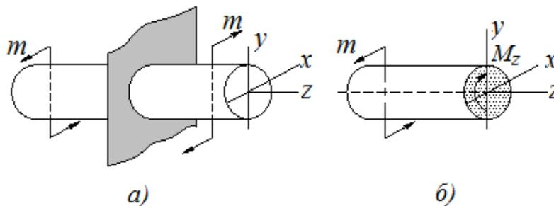
Рис. 135. Вал, работающий на кручение
