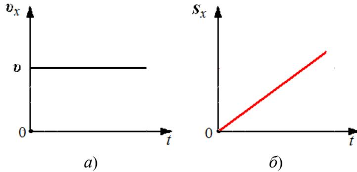
Рис. 61. Графики зависимости: а – скорости от времени; б – перемещения от времени
