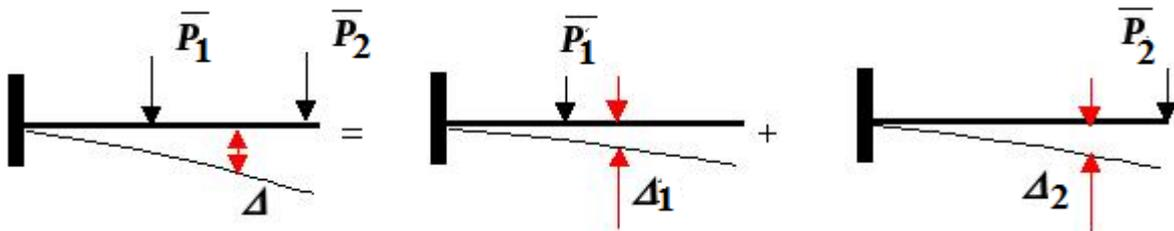
Рис. 113. Принцип независимости действия сил
