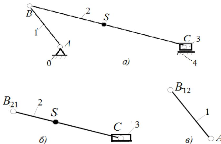
Рис. 146. Структурный анализ механизма: а – кинематическая схема механизма; б – первая структурная группа; в – вторая структурная группа
