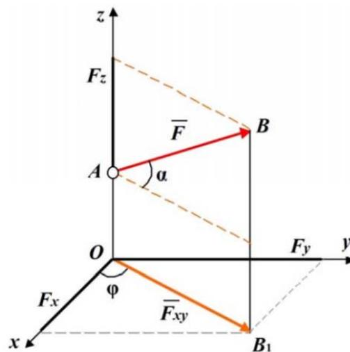
Рис. 19. Проекция силы на плоскость  $xOy$
