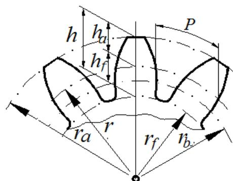
Рис. 156. Профиль зубчатого колеса
