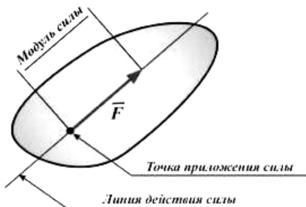
Рис. 2. Графическое представление силы
