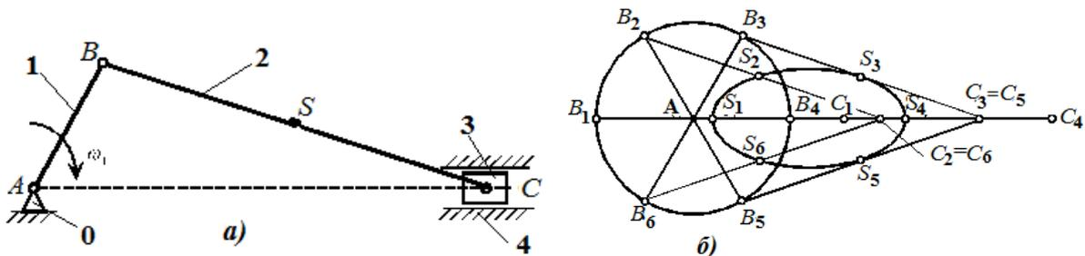
Рис. 147. Рычажный механизм: а – кинематическая схема механизма; б – план шести совмещённых положений механизма
