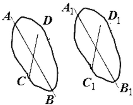
Рис. 64. Поступательное движение твёрдого тела
