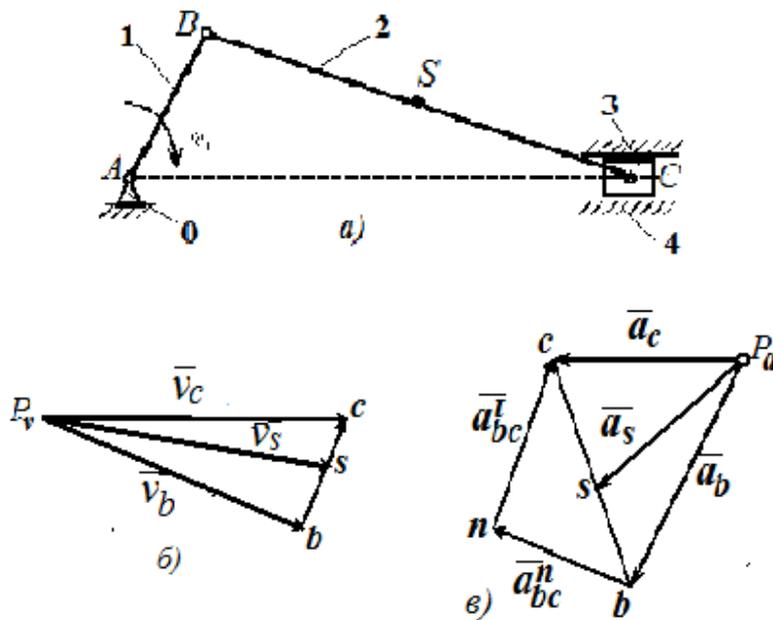
Рис. 148. Кривошипно-ползунный механизм:
