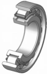
Рис. 188. Роликовый радиальный подшипник
