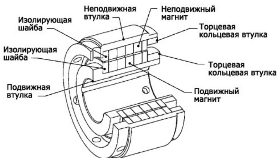
*Рис. 193. Пассивный магнитный подшипник на основе высокоэнергетических постоянных магнитов*
