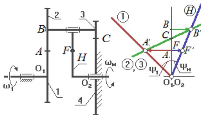
Рис. 160. Редуктор Давида: 1, 2 – внешняя зубчатая пара; 3 – колесо; 4 – коронная шестерня; H – водило
