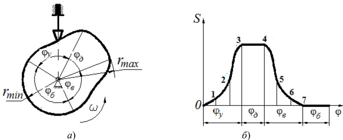
Рис. 167. Профилирование кулачка: а – схема механизма; б – диаграмма движения толкателя
