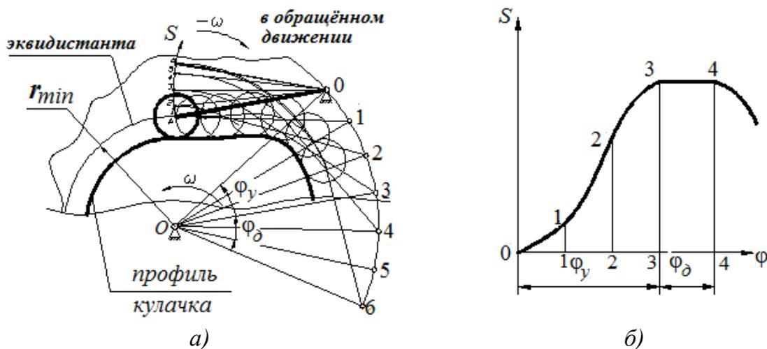
Рис. 169. Профилирование кулачка: а – профиль кулачка; б – диаграмма толкателя
