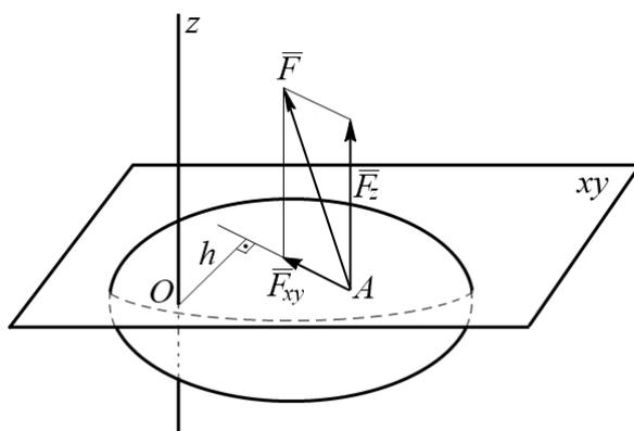
Рис. 32. Момент силы относительно оси  $z$
