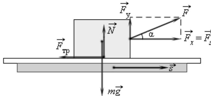
Рис. 83. Механическая работа силы  $F$
