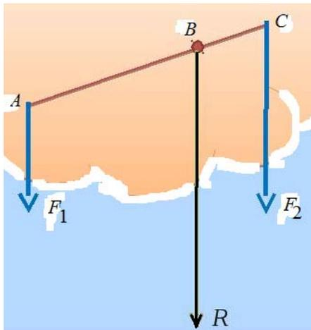
Рис. 24. Сложение параллельных сил
