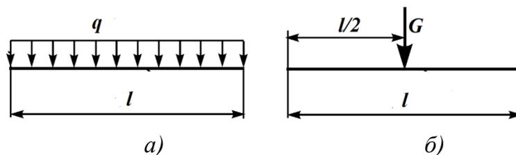
Рис. 4. Силы: а – равномерно распределённые; б – сосредоточенная
