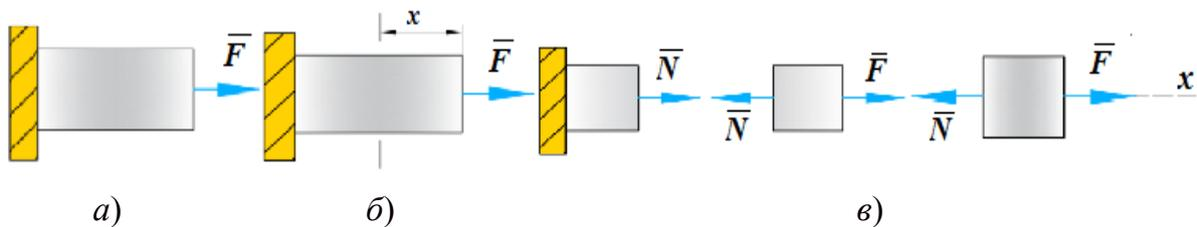
Рис. 122. Определение продольной силы  $N$
