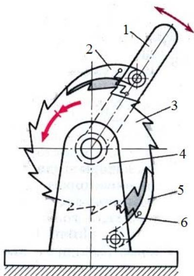
Рис. 162. Храповой механизм
