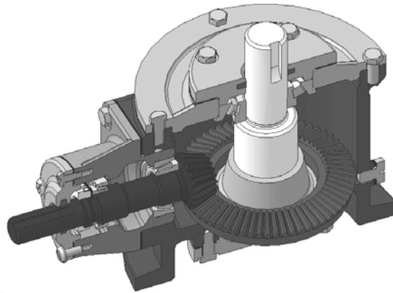
*Рис. 201. Конический редуктор*
