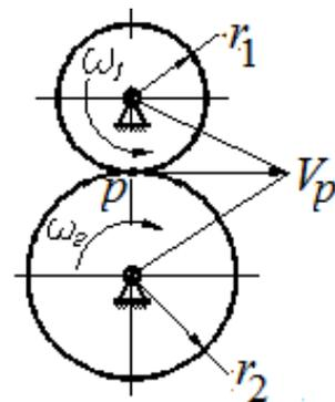
Рис. 153. Схема зубчатой передачи
