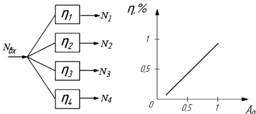
Рис. 150. Параллельное соединение
