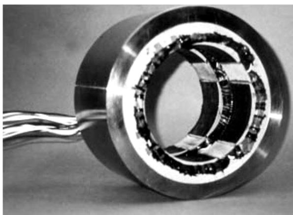
Рис. 192. Общий вид магнитного подшипника
