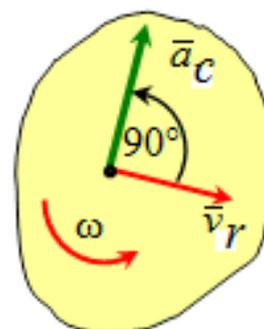
Рис. 77. Вектор относительной скорости  $\mathbf{v}_r$
