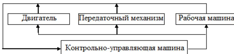
Рис. 144. Схема агрегата
