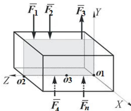
Рис. 23. Система параллельных сил, расположенных в одной плоскости
