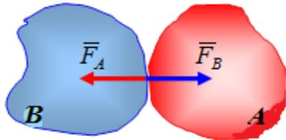
Рис. 15. Силы противодействия
