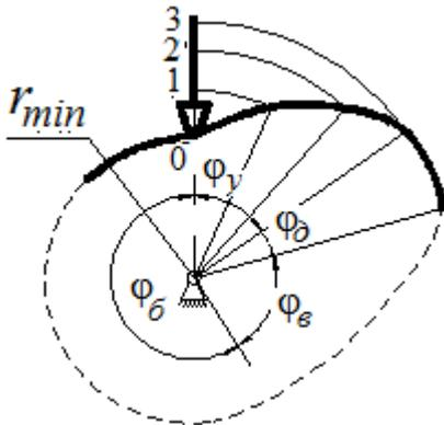
Рис. 168. Профилирование кулачка с поступательным толкателем
