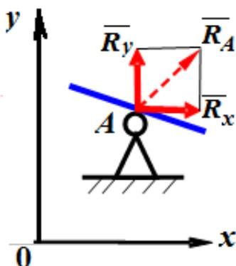
Рис. 10. Шарнирно-неподвижная опора
