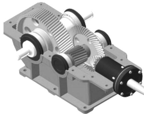
*Рис. 203. Коническо-цилиндрический редуктор*
