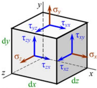
Рис. 120. Нормальные и касательные напряжения в «точке»
