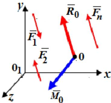
Рис. 48. Равновесие плоской системы сил
