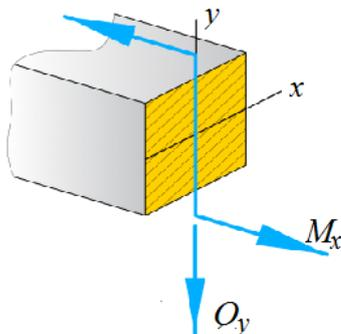
Рис. 131. Поперечный изгиб
