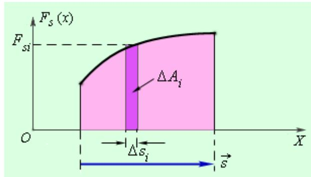
Рис. 84. Графическое определение работы
