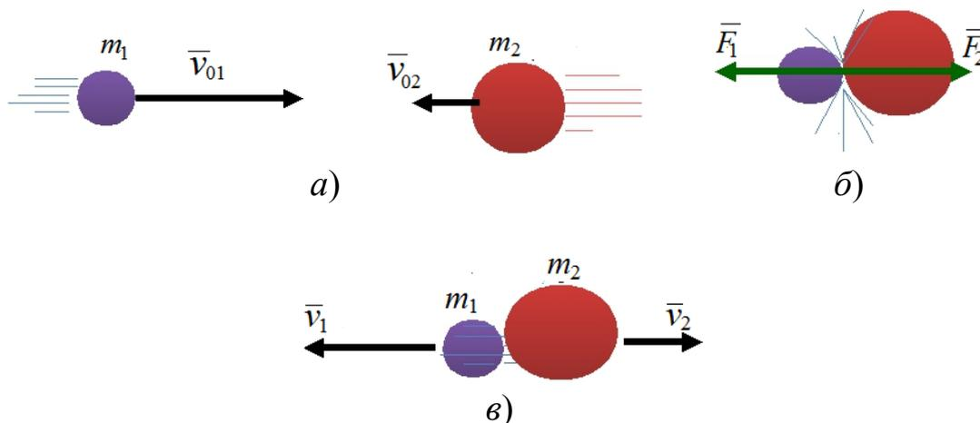
Рис. 107. Абсолютно упругий удар: а – до взаимодействия; б – взаимодействие; в – после взаимодействия
