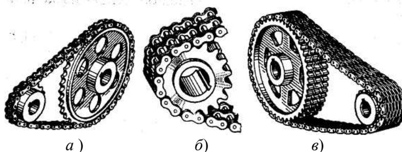
Рис. 179. Типы цепных передач: а – с роликовой цепью; б – с втулочной цепью; в – с зубчатой цепью
