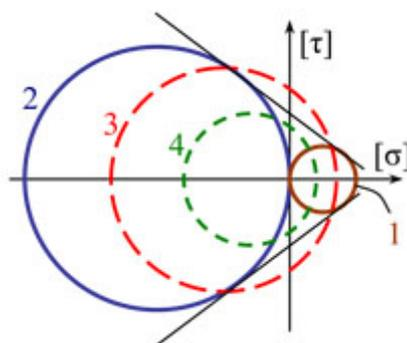
Рис. 139. Круги Мора: 1 – для осевого растяжения; 2 – для осевого сжатия; 3 – для опасного напряженного состояния; 4 – для безопасного напряжённого состояния
