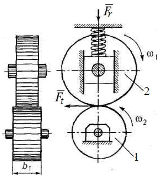
Рис. 177. Цилиндрическая фрикционная передача: 1 – ведущий каток; 2 – ведомый каток
