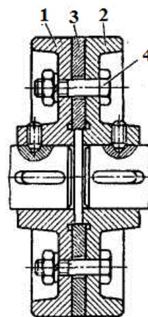
Рис. 195. Фланцевая муфта
