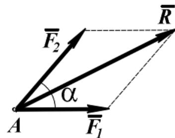
Рис. 14. Равнодействующая двух сил
