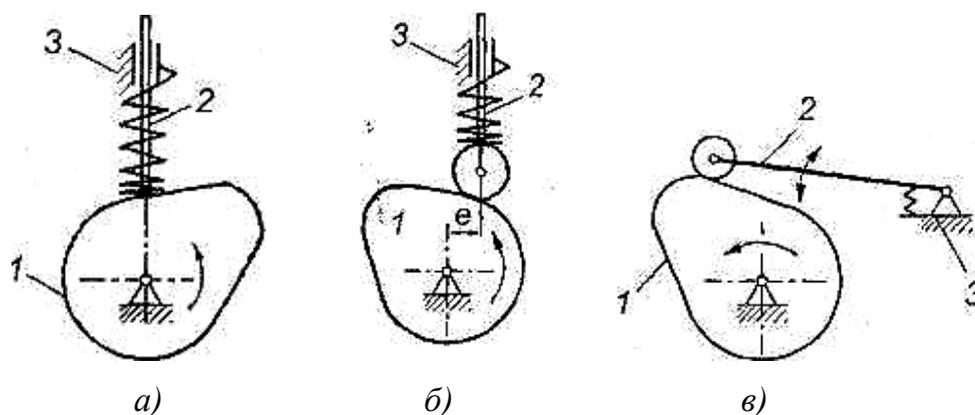
Рис. 163. Кулачковые механизмы с толкателем: а – игольчатым; б – роликовым; в – коромысловым
