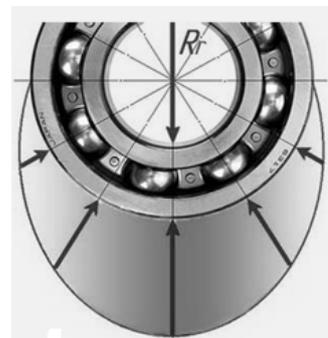
Рис. 190. Распределение радиальной нагрузки между телами качения
