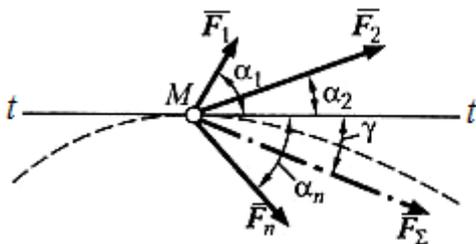
Рис. 85. Работа равнодействующей силы
