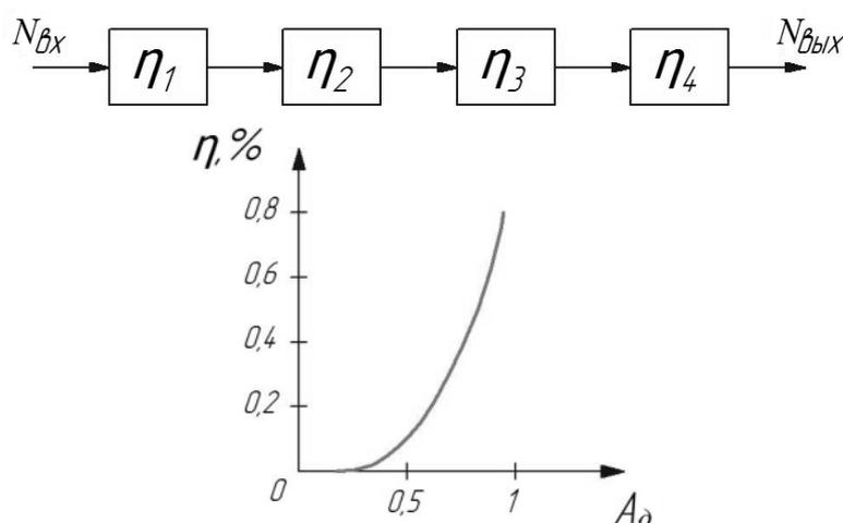
Рис. 149. Последовательное соединение
