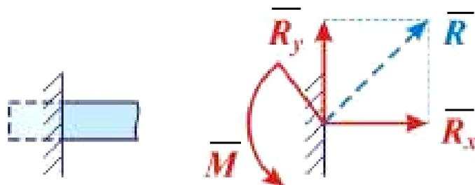
Рис. 11. Схема сил и момента в заделке консольной балки
