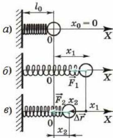
Рис. 97. Работа силы упругости
