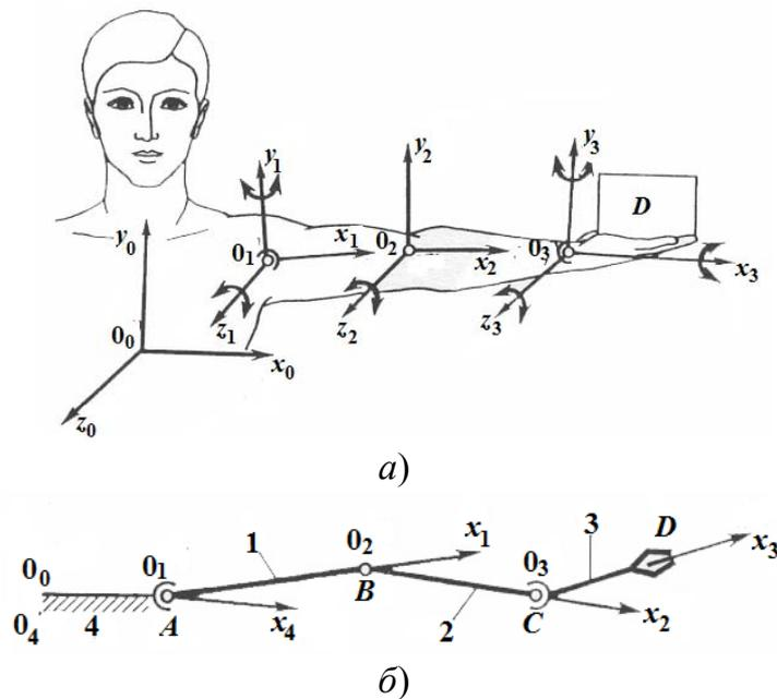
Рис. 170. Выбор кинематической схемы манипулятора
