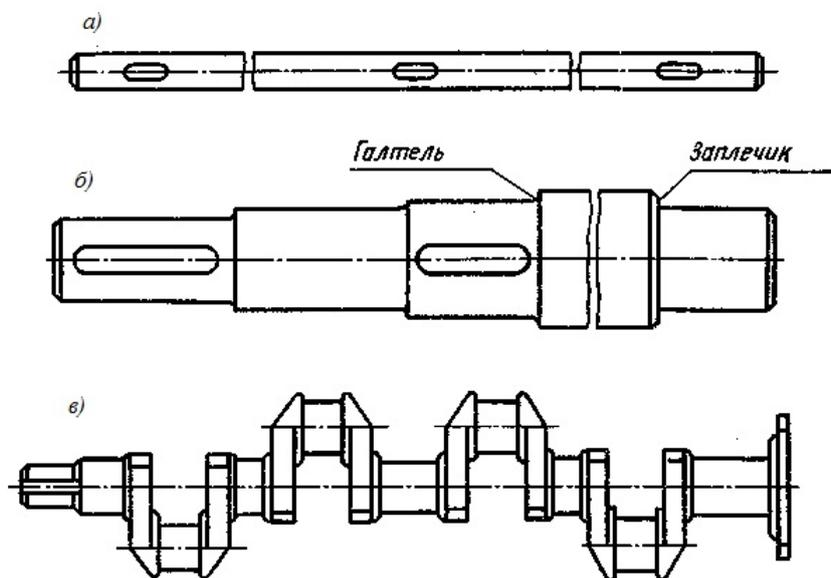
Рис. 183. Валы: а – прямой; б – ступенчатый; в – коленчатый
