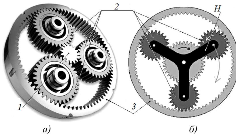
Рис. 158. Планетарный механизм: а – общий вид; б – схема
