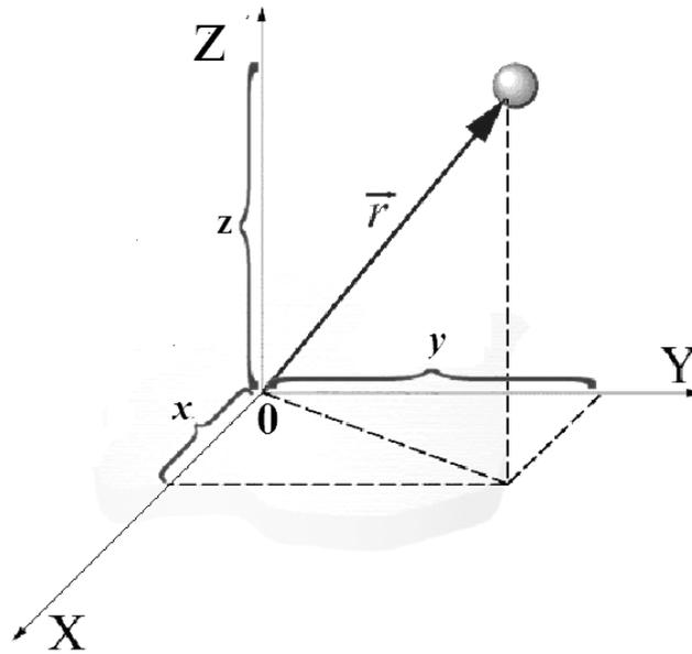
Рис. 57. Связь между координатным и векторным способами
